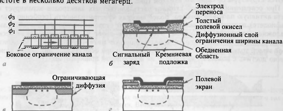
Рис. 21.41. а — схематическое изображение изоляции канала переноса. Поперечное сечение канала с изоляцией посредством изменением толщины окисла (б), сильнолегированными областями (в) и полевым эффектом (г). Из работы [1232]
