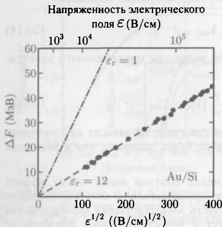
Рис. 20.9. Зависимость величины понижения барьера Шоттки от электрического поля, создаваемого зеркально отображенным зарядом. Штрихпунктирная линия соответствует диэлектрической проницаемости вакуума, а штриховая линия показывает зависимость (20.20) при \epsilon_s = 12 [1129]
