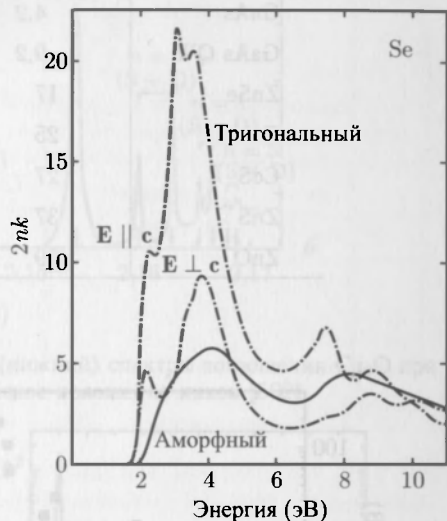
Рис. 9.15. Мнимая часть диэлектрической функции аморфного (сплошная линия) и кристаллического (тригонального) селена (штриховая и штрихпунктирная линии) для двух различных направлений поляризации [584]
