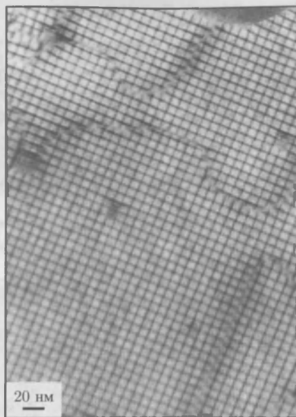
Рис. 4.31. Светлопольное ТЕМ-изображение чистой границы кручения с сеткой чистых дислокаций кручения, полученных соединением на пластине двух Si (001) поверхностей, скрученных относительно друг друга. Источник — [251]
