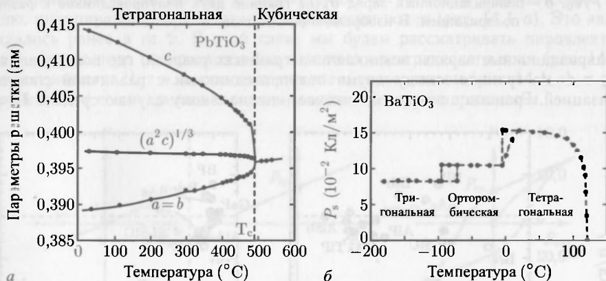
Рис. 14.4. а — параметры решетки \text{PbTiO}_3 как функция температуры [921], б — фазовый переход в \text{BaTiO}_3 как функция температуры. Спонтанная поляризация P_{\text{сп}} направлена вдоль \langle 100 \rangle , \langle 110 \rangle и \langle 111 \rangle в тетрагональной ( C_{4v} ), орторомбической ( C_{2v} ) и тригональной ( C_{3v} , ромбоэдрической) фазах соответственно [922]
