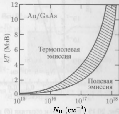
Рис. 20.18. Расчетные диапазоны значения температуры и концентрации легирующих примесей для термополевой (ТПЭ) и полевой (ПЭ) эмиссий в Au/GaAs диодах Шоттки. Заимствовано из [1118]
