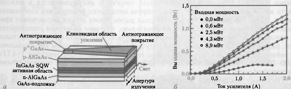
Рис. 22.70. а — схематическое изображение геометрии клиновидного полупроводникового оптического усилителя. б — зависимость выходной оптической мощности от потребляемого тока усилителя при различных значениях входной оптической мощности, угол клина равен 5°. При нулевой входной мощности наблюдается только спонтанное и усиленное спонтанное излучения. Печатается с разрешения [1385]
