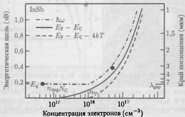
Рис. 9.26. Эффект Бурштейна-Мосса в InSb ( E_g = 0,18 эВ) при комнатной температуре. Теоретические зависимости и экспериментальные точки для собственного InSb и InSb с примесью n -типа 5 \cdot 10^{18} \text{ см}^{-3} . Данные из [616]
