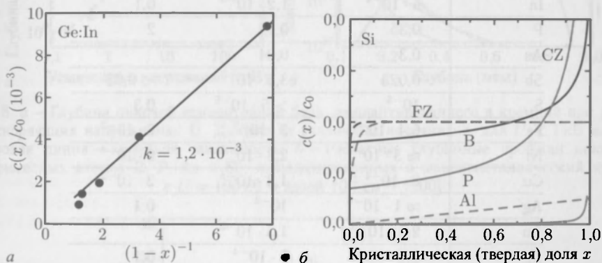
Рис. 4.7. а — Относительная концентрация индия вдоль GZ-выращенного кристалла германия. Абсолютная концентрация порядка 10^{16} \text{ см}^{-3} . Сплошная линия — зависимость (4.18) при k = 1,2 \cdot 10^{-3} . Точки — экспериментальные данные [189]. б — распределение примесей (в относительных концентрациях c(x)/c_0 для CZ (4.18) (сплошные линии) и FZ (4.20) (штриховые линии, z = 0,01 ) в кристаллах кремния для B, P и Al. Значения коэффициентов сегрегации взяты из табл. 4.2. Заметим, что точка пересечения зависимостей B и P отвечает изменению типа проводимости (ср. с рис. 1.4)
