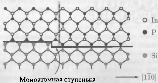
Рис. 4.34. Моноатомная ступенька на Si(001) поверхности и последующее последовательное формирование границы противофазы в InP (цинковой обманке)
