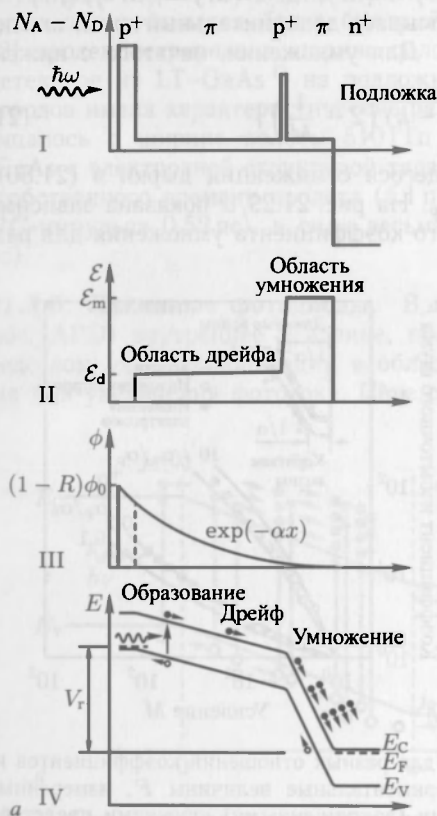
Рис. 21.30. а — гомогенный ЛФД с SAM структурой: профиль легирования (i), электрическое поле (ii), плотность потока фотонов или скорость генерации электронно-дырочных пар (iii) и схематическая зонная диаграмма с движением носителей заряда при обратном смещении V_r (iv). Умножение происходит при \alpha_n \gg \alpha_p . Из работы [183]. б — схема SAM-ЛФД на гетероструктуре InP/InGaAs (i), профиль легирования (ii) и электрическое поле при малом (пунктир) и большом (сплошная) обратном смещении V_r (iii). Из работы [795]
