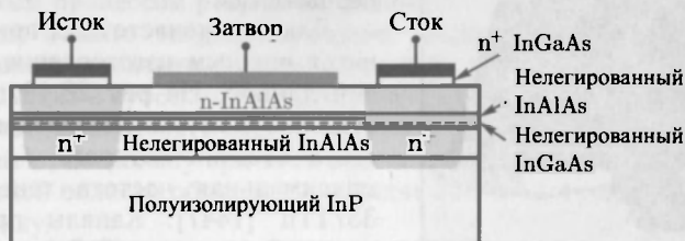
Рис. 23.47. Схема гетероструктуры PHEMT \text{n-AlInAs/InGaAs/InAlAs} на полуизолирующем InP. Области под омическими контактами стока и истока, включая и слой InGaAs, сильно легированы \text{n} -примесью. Такая структура представляет собой \text{n} -канальный HEMT-транзистор. Горизонтальная штриховая линия схематично показывает расположение двумерного электронного газа в слое InGaAs
