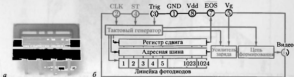
Рис. 21.45. а — линейный КМОП-сенсор в 8-ми выводном корпусе, б — его блок-схема. Встроенный генератор управляющих импульсных последовательностей позволяет обходиться только стартовым и тактовым входами. Воспроизведено с разрешения [1234]
