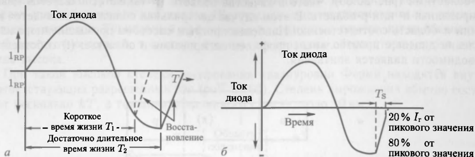
Рис. 20.63. а — осциллограмма зависимости тока от времени для диодов с накоплением заряда при синусоидальном входном напряжении. Время жизни должно быть настолько большим, чтобы ток смог достичь своего пикового значения. б — определение времени восстановления T_s . Печатается с разрешения [1192]
