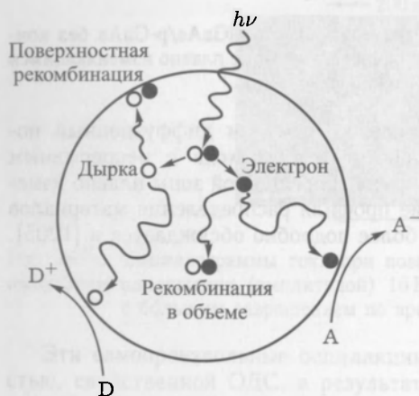
Рис. 21.1. Принцип фотокаталитической активности. Поглощение света создает электронно-дырочные пары. Электроны и дырки диффундируют и могут либо рекомбинировать в объеме или на поверхности, либо вступить в реакцию с молекулами окружающего раствора, забирая электроны от акцептороподобных и снабжая электронами донороподобные молекулы раствора [1206]
