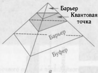
Рис. 13.22. Квантовые точки различных конфигураций, полученные с использованием литографии и травления [890]
