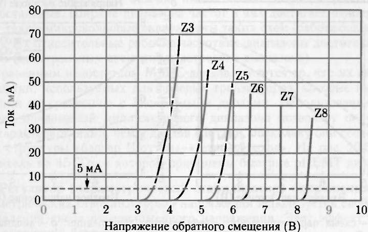
Рис. 20.59. Обратные характеристики совокупности диодов Зенера, отличающихся напряжением стабилизации (при комнатной температуре)
