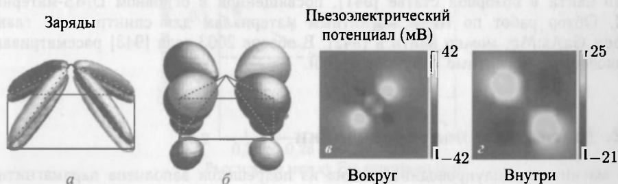
Рис. 14.16. a — пьезоэлектрические заряды и б — результирующий кулоновский потенциал в \text{InAs/GaAs} квантовой точке с базовой длиной b = 12 нм. a — изоповерхности, отвечающие объемным зарядам \pm 0,3e\text{ нм}^{-3} . б — изоповерхности для кулоновского потенциала \pm 30 МэВ в поперечном сечении квантовых точек, сделанного несколько выше смачивающего слоя, при различных увеличениях. Увеличение в ( г ) больше, чем в ( б ). Граница \text{InAs/GaAs} видна в ( г ) за счет действия зарядов изображения. Части ( a ) и ( б ) перепечатаны из [288], с разрешения ©1995 APS
