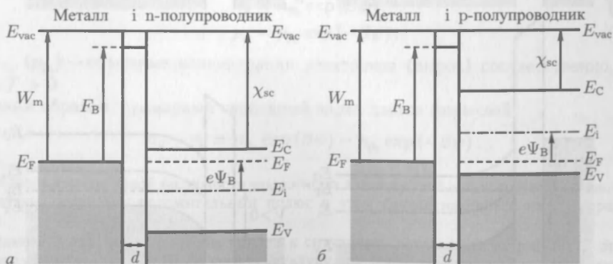
Рис. 20.27. Зонная диаграмма идеального МДП-диода с полупроводником п- (а) и р-типа (б) при внешнем напряжении смещения V = 0 . Толщина диэлектрика («i») обозначена как d . Штрихпунктирная линия показывает собственный уровень Ферми E_i
