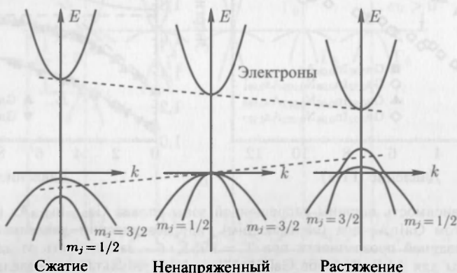
Рис. 6.38. Схемы зонной структуры GaAs: в ненапряженном состоянии (в центре); под действием сжимающих (слева) и растягивающих (справа) двусосных напряжений. Штриховая линия указывает сдвиги краев зон при гидростатическом сжатии
