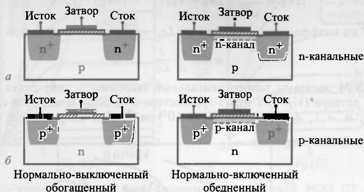
Рис. 23.25. Четыре типа МОП-транзисторов. а — обогащенный и обедненный МОП-транзисторы с n-каналом и б — обогащенный и обедненный МОП-транзисторы с p-каналом
