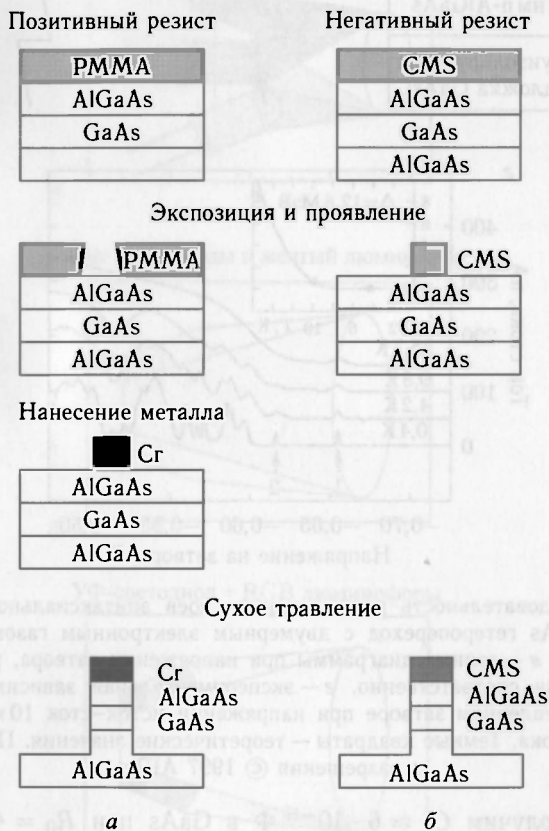
Рис. 13.21. Методы литографии и травления, применяемые для приготовления полупроводниковых структур
