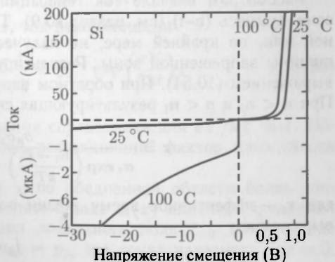
Рис. 20.44. Характеристики мощного кремниевого (Si) диода при двух различных температурах, 25 и 100 °C
