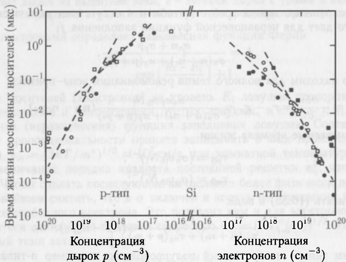
Рис. 10.28. Время жизни неосновных носителей при комнатной температуре как функция концентрации основных носителей в кремнии p- и n-типа. У штриховых линий наклон N^{-1} , N^{-2} . Данные из [725]
