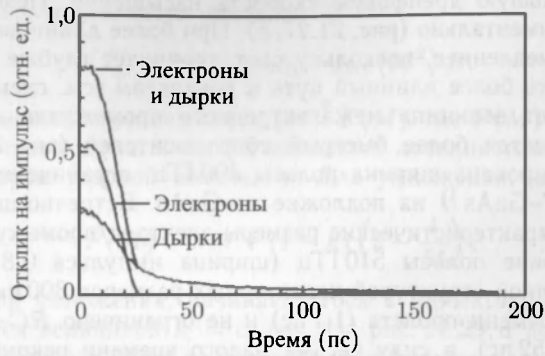
Рис. 21.26. Результаты моделирования временной зависимости отклика МПМ-фотодетектора на основе InGaAs:Fe на короткий световой импульс [1221]
