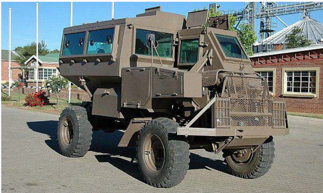
Рис.4. Один из основоположников MRAP бронетранспортер Buffel производства ЮАР, созданный с использованием узлов автомобиля Unimog
