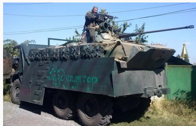
Рис.13. Шушпанцер «Раздуплятор» на основе Камаза и БМД-2 ВС Новоросии.
