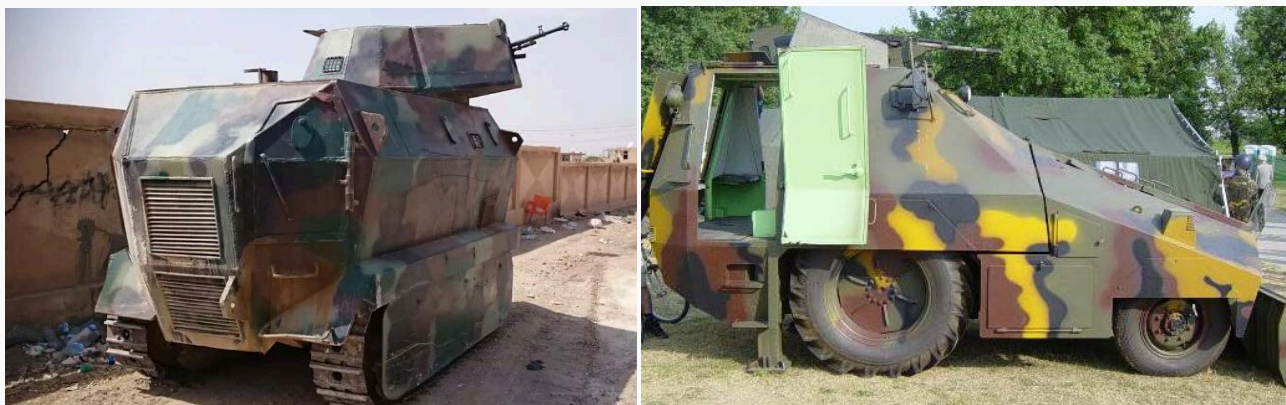
Рис.10-11. Шурпанцеры на основе гусеничного (Курдистан) и колесного (Хорватия) тракторов.
