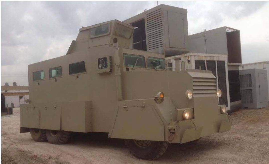
Рис.8. Классический шушпанцер с навесной броней
