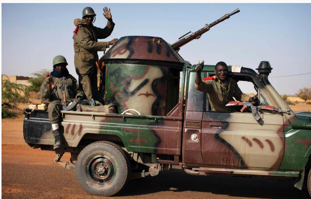
Рис.7. Шушпанцер с башней от БТР с пулеметом КПВТ, вооруженные силы Мали
