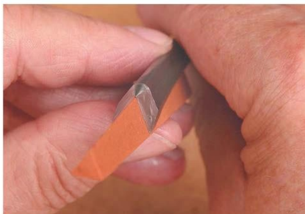
Треугольный камень Индия используется для снятия заусенцев на внутренней поверхности стамески-уголка 60 градусов.
