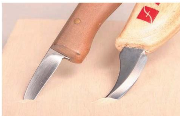
При погружении лезвия в древесину легче наблюдать, в каком месте древесины находится кончик прямого лезвия, чем кончик закругленного лезвия.
