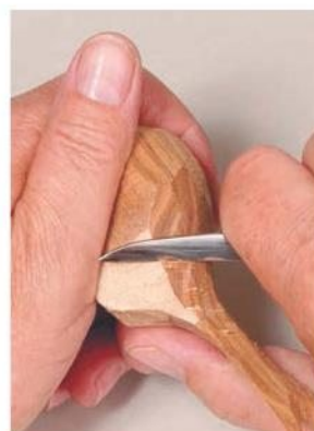
Многие люди получают порезы на руках при работе с длинными ножами, поскольку основное внимание уделяют участку резьбы, а не тому месту, где выступает кончик ножа.
