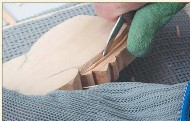
39 Выделите мешок. Делайте надрезы ножом, снимая древесину с задней части мешка.
