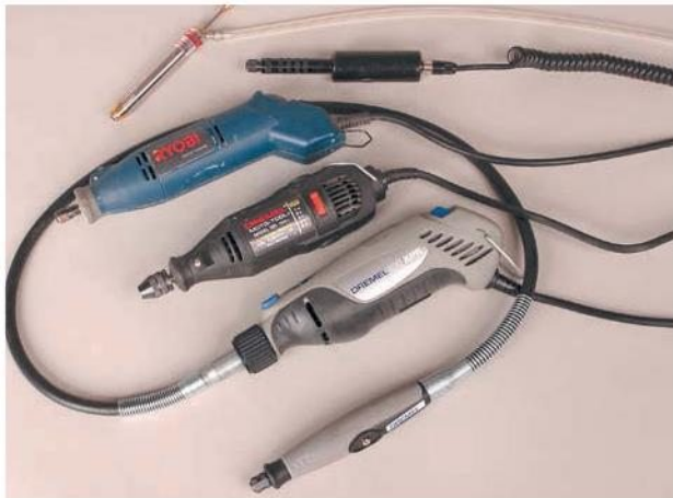
У большинства бормашин есть возможность смены цанг для зажима фрез с разным диаметром хвостовика.
