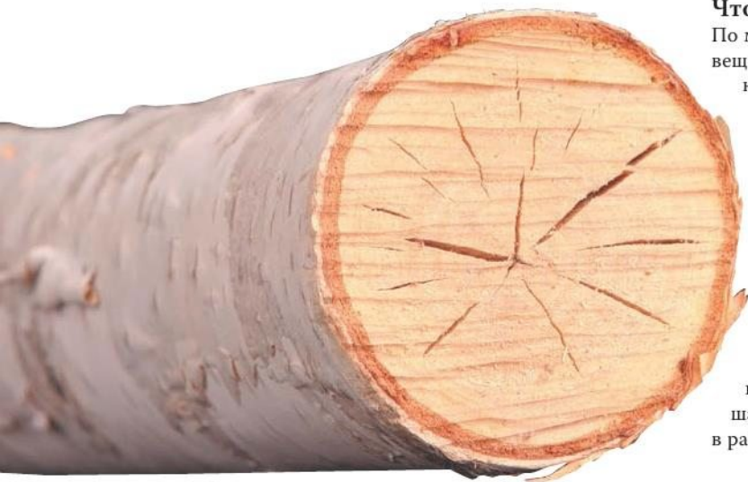
На бревне образуются радиальные трещины, когда сосуды разрезаются. Очевидно, что это происходит на концах древесных волокон.
