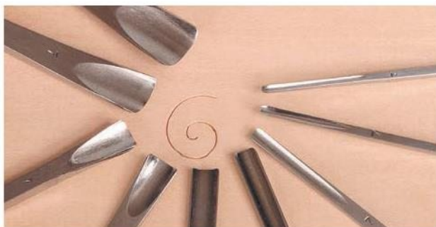
Спираль, полученная при последовательном накалывании на дереве контура стамесками с профилем № 7, начиная с лезвия шириной 3 мм и заканчивая лезвием шириной 20 мм. При последовательном накалывании контура стамесками № 5 получится широкая спираль, а при накалывании контура стамесками № 9 образуется более плотная спираль.
