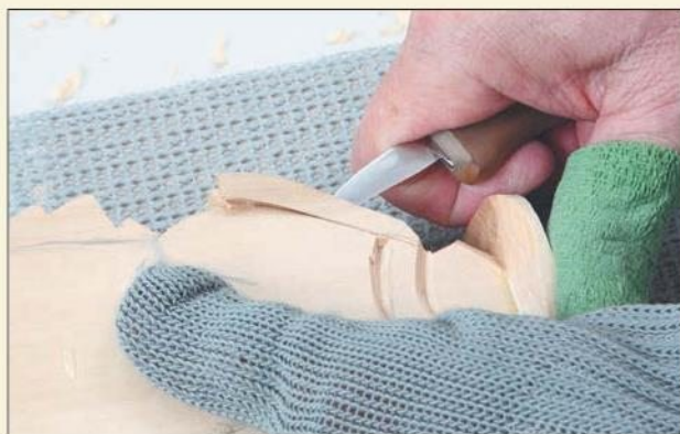
37 Придайте шарфу форму. Сделайте надрез по линии спины. Поверните фигуру и сделайте надрез по боковой линии, чтобы срезать древесину за шарфом.
