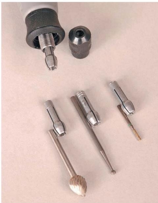
Цанга вставляется непосредственно в наконечник портативной или стационарной бормашины. Для резьбы по дереву используются фрезы разных форм и размеров.
