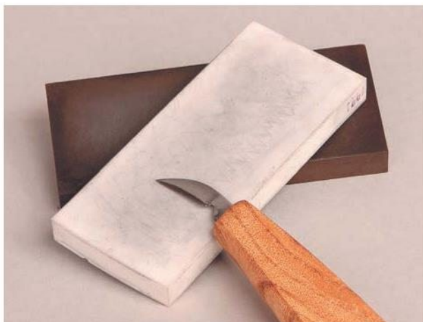
Керамические камни не предназначены для грубой заточки. Они бывают двух цветов — белого и черного.
