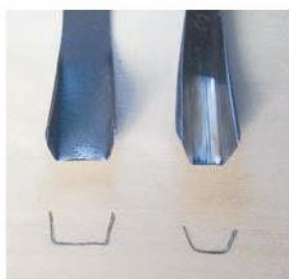
Остроканальная стамеска (слева) и круглоканальная стамеска (справа).
