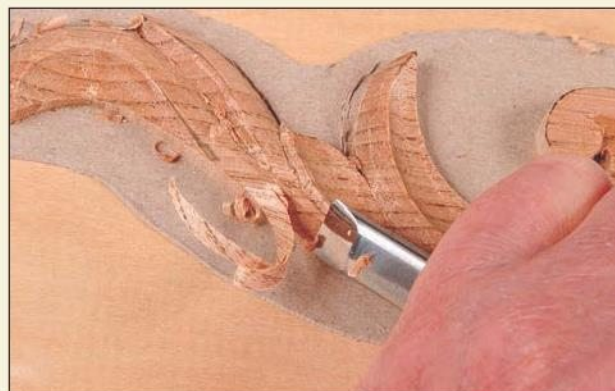
25 Закруглите эту область, двигаясь лезвием от положительной точки перехода.
