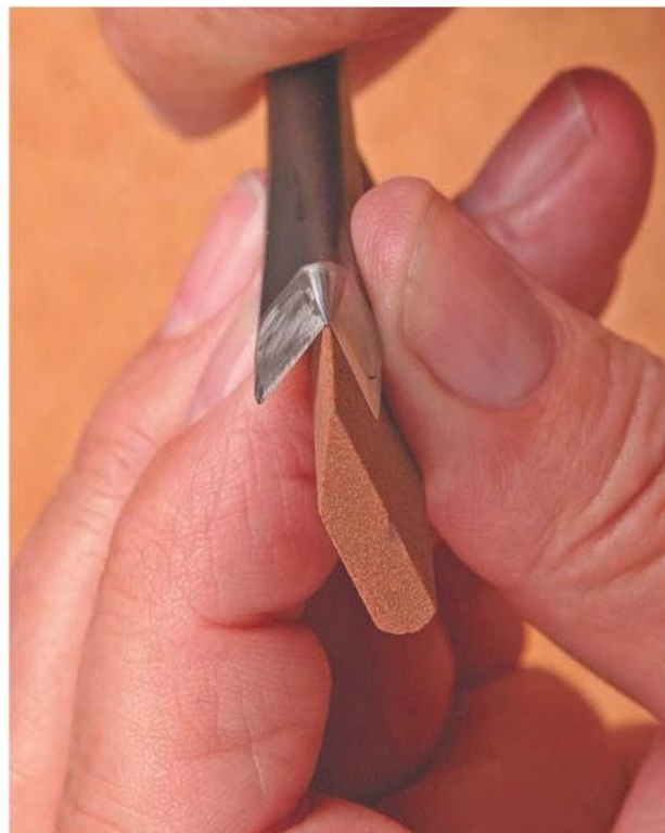
Используйте острый оселок для обработки стамесок с углом менее 60 градусов.
