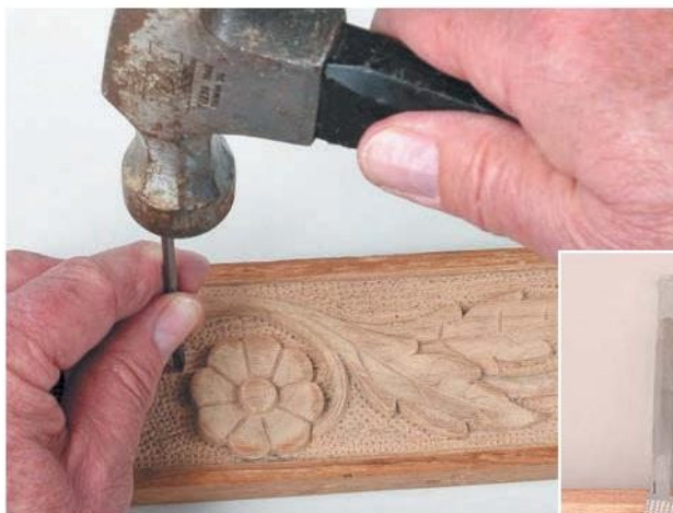
Чеканы можно купить в специализированных магазинах или изготовить самостоятельно. Мастера, вырезающие рельефы, часто используют чеканы для набивки фона.
