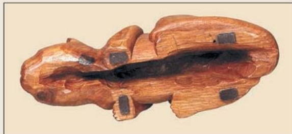
Выдалбливайте полости для снижения напряжения в заготовке
