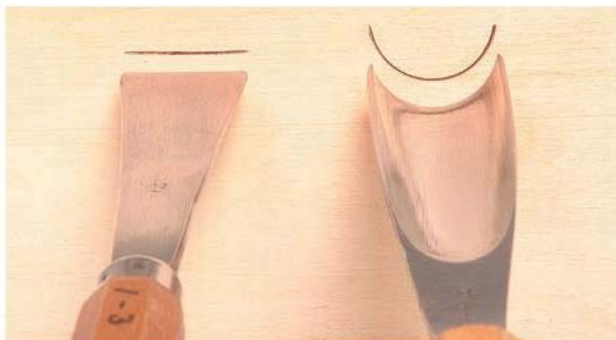
Сравните режущие кромки стамески № 3 (очень легкий изгиб) и № 9 (более значительный изгиб).
