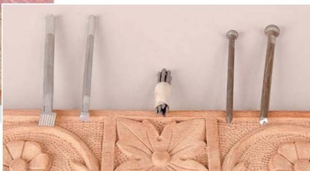
Чеканы можно купить в специализированных магазинах или изготовить самостоятельно. Мастера, вырезающие рельефы, часто используют чеканы для набивки фона.
