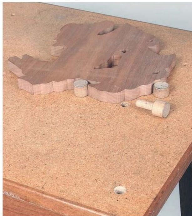
Деревянные колышки-«собаки» — это универсальные прижимы для объектов неправильной формы.
