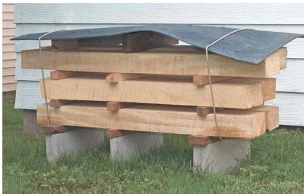
При сушке на воздухе используют бруски-разделители между рядами, чтобы обеспечить свободную циркуляцию воздуха вокруг каждой заготовки.
