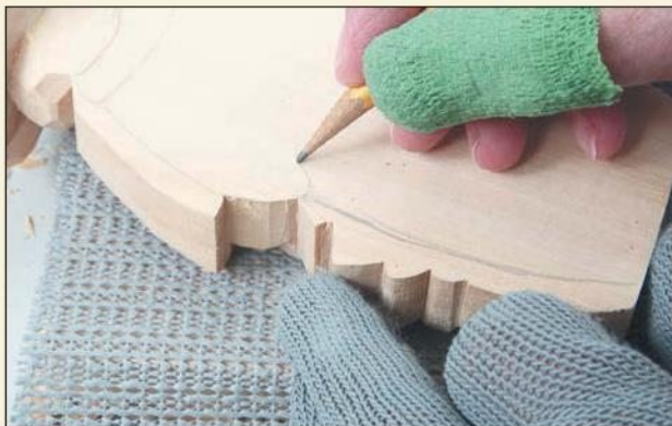
34 Разметьте заготовку с обратной стороны. Поверните Снеговика и разметьте заготовку с обратной стороны.
