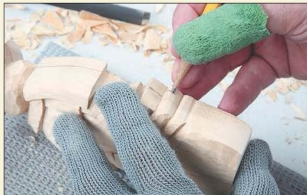
35 Нарисуйте контур сбоку фигуры. С помощью боковой разметки определите сколько древесины нужно срезать возле шарфа и как сформировать заднюю часть сумки.
