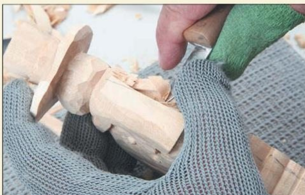
38 Продолжайте срезать лишнюю древесину, пока не вырежете полностью шарф, свисающий сбоку.
