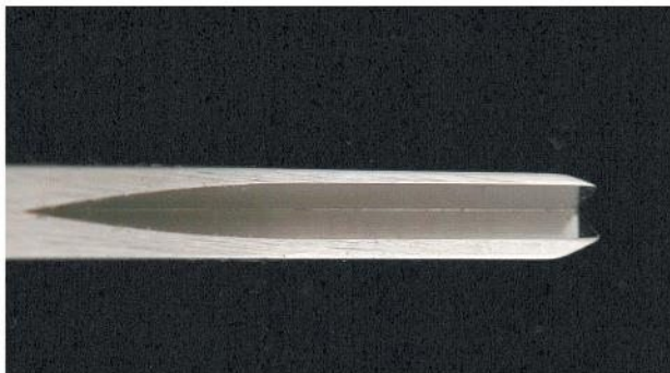
Оба крыла лезвия стамески-уголка должны быть одинаковой толщины, чтобы правильно резать.
