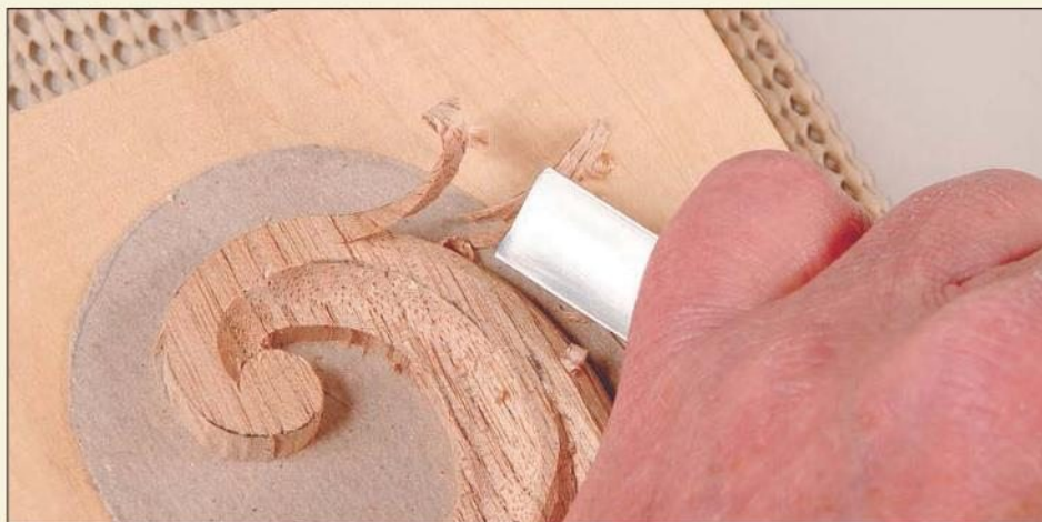
26 Разверните заготовку и так же, двигаясь от положительной точки перехода, закруглите область с другого конца фигуры. Здесь будут полезны стамески № 5 шириной 15 мм и 20 мм. При вырезании акантовых орнаментов полезно иметь полукруглые стамески, совпадающие по радиусу изгиба с выпуклыми и вогнутыми поверхностями, чтобы за один рез можно было сделать нужную форму.
