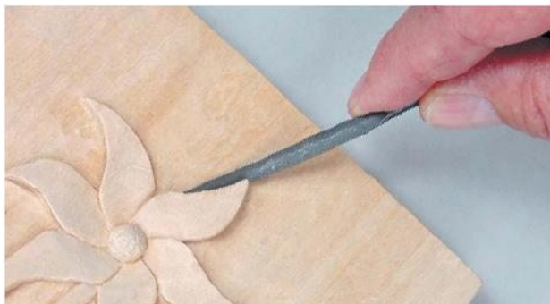
Мини-рашпили превосходно справляются со шлифовкой поднутрений и других труднодоступных мест.
