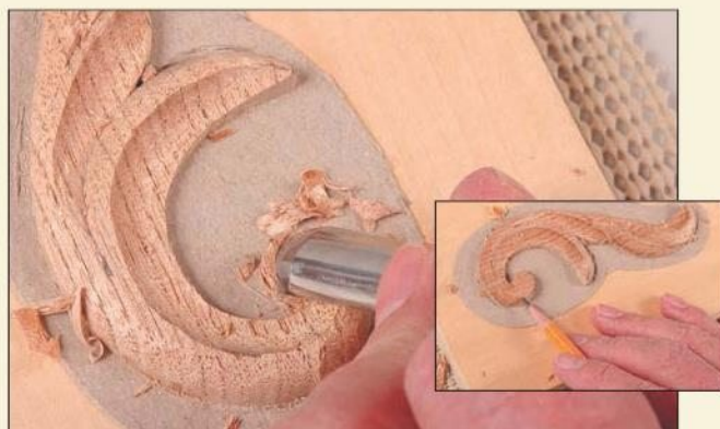
28 Закруглите кромки кнопки-завитка стамеской № 9 шириной 10 мм. Здесь еще одна точка перехода, в которой нужно работать резцом осторожно.
