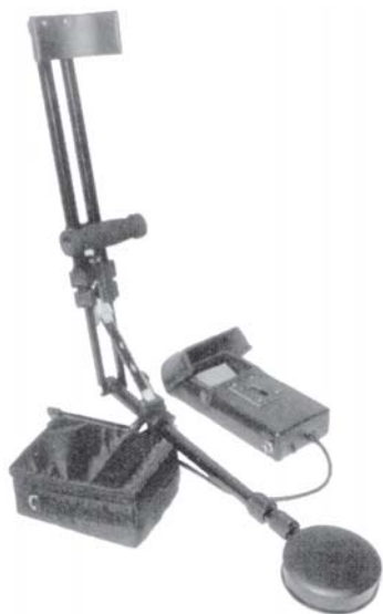
Рис. 5.8. Система для досмотра автотранспорта S-1100 («Дозор»)
