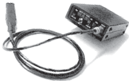
Рис. 2.70. Портативный обнаружитель диктофонов TRD-800
