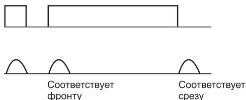
Рис. 4.4. Видеосигналы в дисплее и ТВ-приемнике
