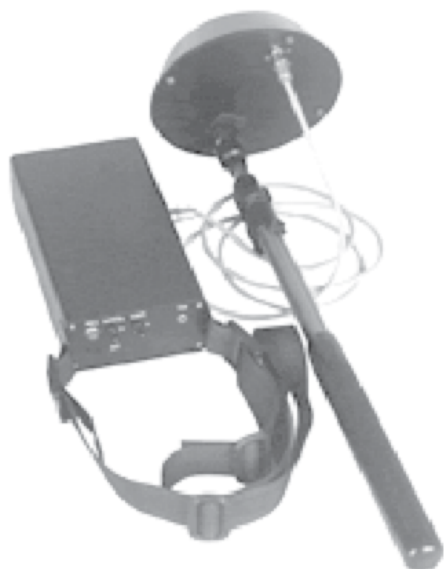
Рис. 2.54. Портативный нелинейный радиолокатор «Родник»
