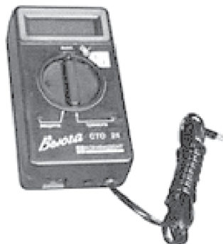
Рис. 3.19. Устройство защиты телефонных переговоров СТО-24 «Вьюга»
