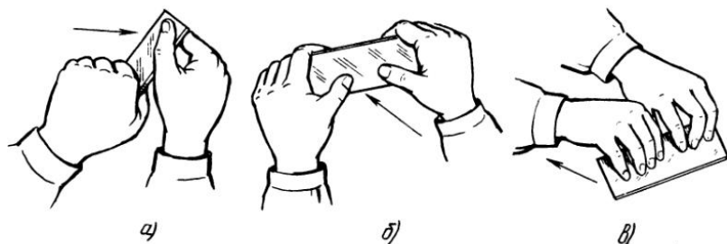
Рис. 42. Приемы работы циклей:
