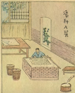
Рис. 317. Изготовление бумаги в Китае. (Старинные китайские изображения.) В котле варят бумажную массу. Работник сеткой черпает слой полужидкой массы, образующий лист бумаги. Эта масса течет по трубе. Сзади сложены листы бумаги.
