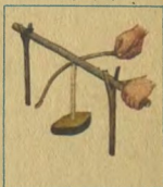
Рис. 39. Сверление камня.
