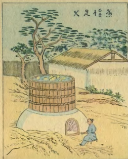
Рис. 317. Изготовление бумаги в Китае. (Старинные китайские изображения.) В котле варят бумажную массу. Работник сеткой черпает слой полужидкой массы, образующий лист бумаги. Эта масса течет по трубе. Сзади сложены листы бумаги.
