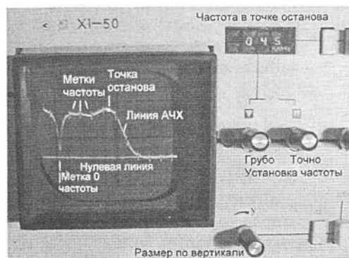
Рис. 2.71. Часть передней панели прибора Х1-50 с осциллограммой АЧХ
