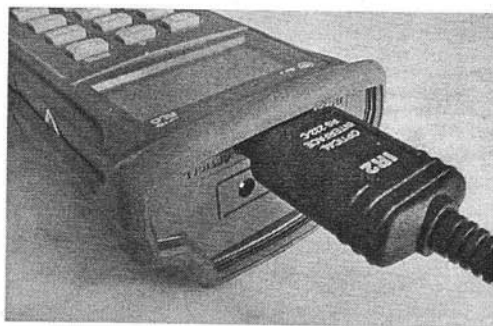
Рис. 1.13. Подключение интерфейсного кабеля с блоком оптической развязки к измерителю E7-22
