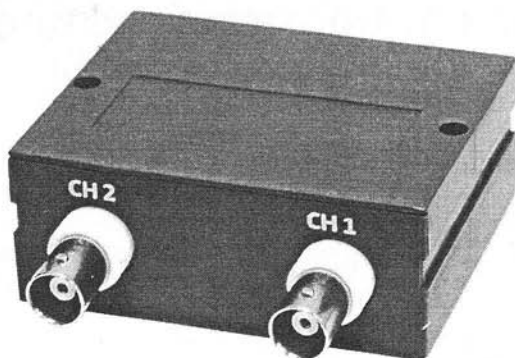
Рис. 6.2. Сменный модуль осциллографа АСК-4201
