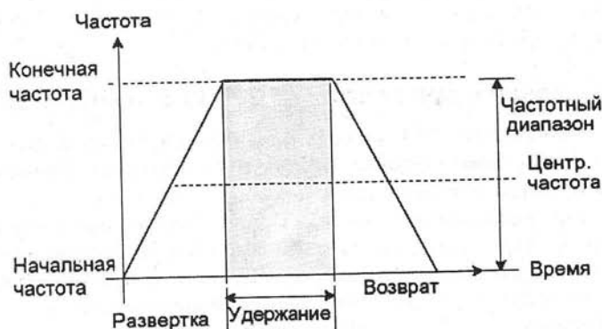
Рис. 2.124. Зависимость частоты от времени в режиме качания (сweep-генератора)
