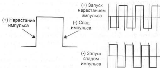
Рис. 8.16. Влияние полярности запуска развертки при просмотре прямоугольных импульсов
