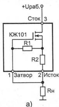
Рис. 2.24. Основные схемы включения микросхемы КЖ101А
