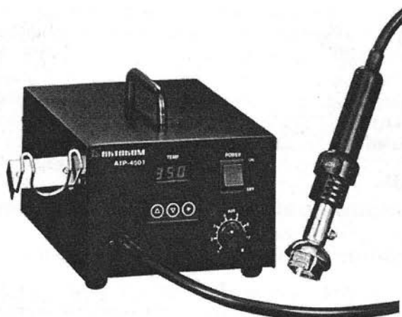
Рис. 10.10. Паяльная станция ATP-4501 с пайкой горячим воздухом
