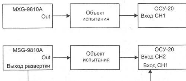
Рис. 2.66. Блок-схемы построения АЧХ объекта
