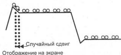
Рис. 8.60. К дискретизации со случайным выбором отсчетов
