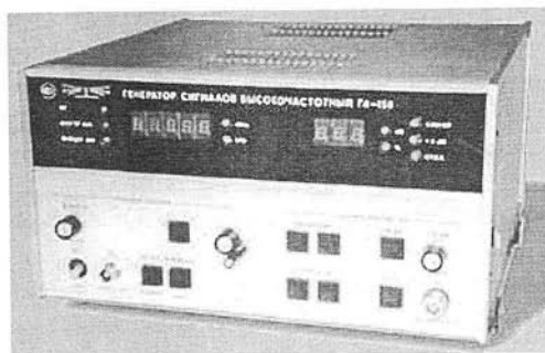
Рис. 2.44. Современный ВЧ ГСС Г4-158А
