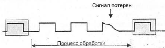
Рис. 8.51. Осциллографирование импульсов цифровым осциллографом с памятью на один импульс
