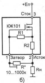
Рис. 2.24. Основные схемы включения микросхемы КЖ101А
