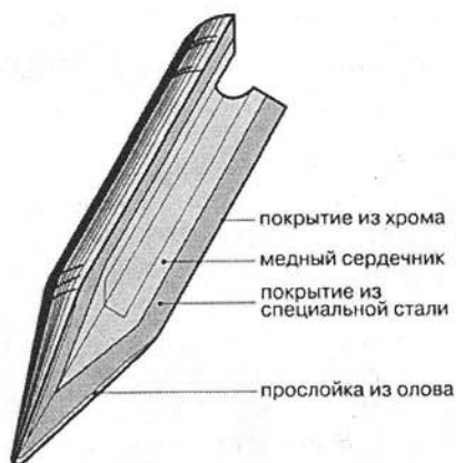
Рис. 10.4. Конструкция жала паяльников АКТАКОМ
