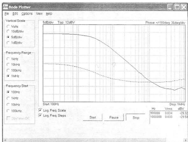
Рис. 9.46. Построение АЧХ и ФЧХ дифференцирующей RC-цепи
