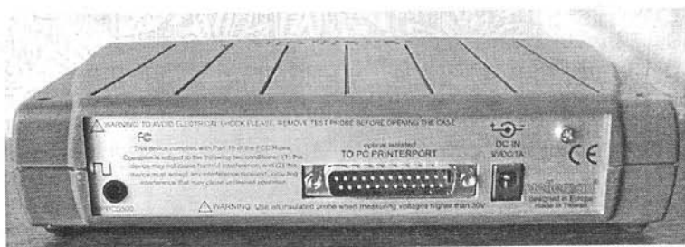
Рис. 7.2. Внешний вид приставки PCS500 сзади
