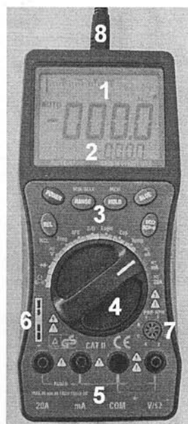
Рис. 1.46. Органы управления мультиметром
