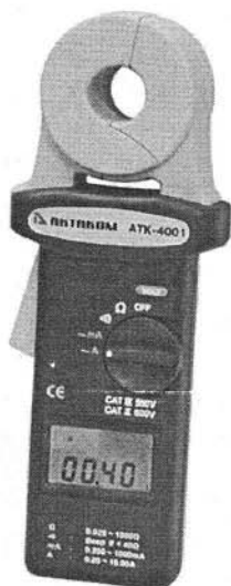
Рис. 1.32. Токовые клещи для измерения сопротивления ATK-4001
