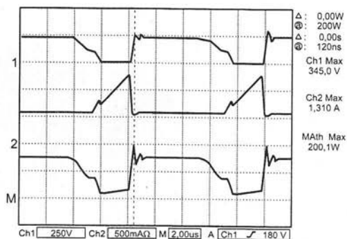
Рис. 8.74. Серия осциллограмм для ключа на мощном полевом транзисторе
