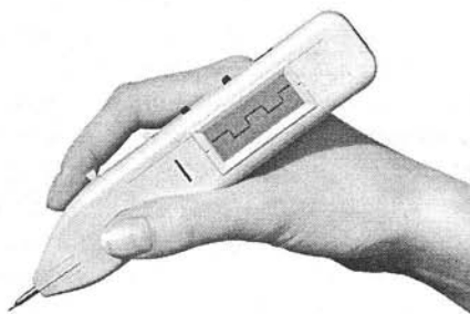
Рис. 6.3. Минискос (осциллограф-щуп) АСК-4011
