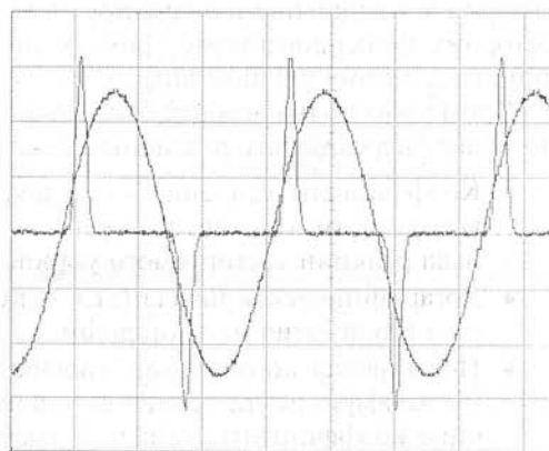
Рис. 9.75. Пример определения сдвига фаз между сигналами, один из которых не синусоидальный
