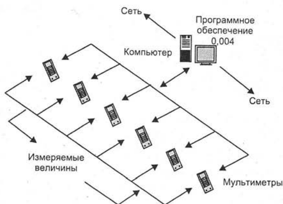
Рис. 1.14. Функциональная схема компьютерной сети с измерителями — мультиметрами, измеряющими различные параметры
