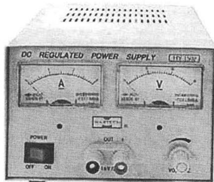
Рис. 2.25. Одноканальный лабораторный источник питания HY1502 со стрелочными измерителями напряжения и тока
