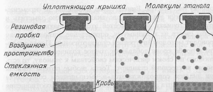
Рис. 3.14. Схематическое изображение процесса перехода молекул этанола из пробы крови в воздушное пространство стеклянной емкости. а—исходное состояние; б—равновесие еще не достигнуто; в—равновесие достигнуто.
