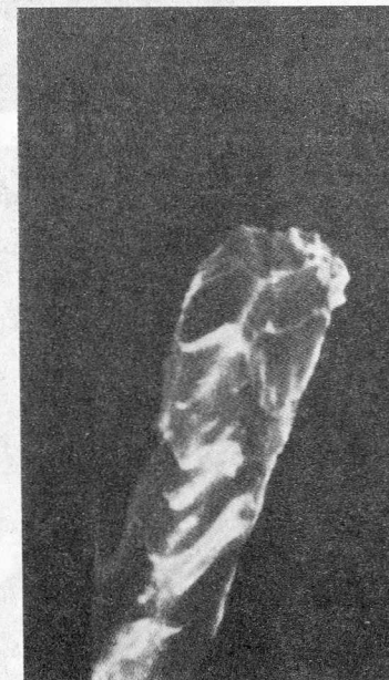
Рис. 2.1. Фотографии разрезанных волокон в растровом электронном микроскопе. Увеличение \times 1000 . а — вискоза; б — шерсть.
