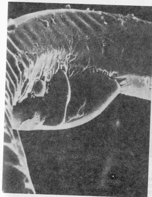
Рис. 2.30. Следы окисления вольфрамовой спирали, оборванной в горячем состоянии; на спирали видны образовавшиеся при обрыве шарики расплава. Стеклянная колба лампы осталась неповрежденной.
