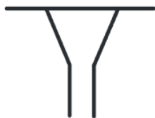
Рисунок 20 – Условное обозначение полуволнового вибратора с шунтовым питанием
