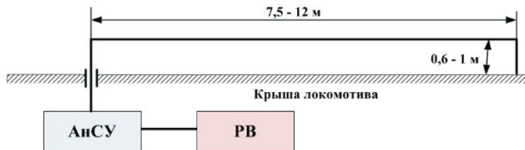
Рисунок 77 – П-образная заземленная локомотивная антенна
