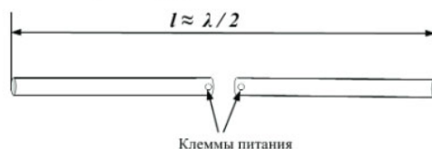
Рисунок 28 – Полуволновой вибратор
