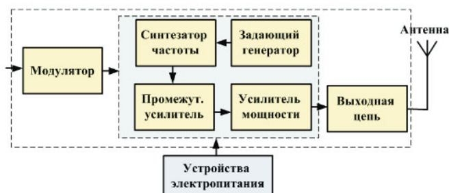
Рисунок 9 – Функциональная схема радиопередатчика
