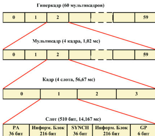
Рисунок 99 – Временная структура физического канала
