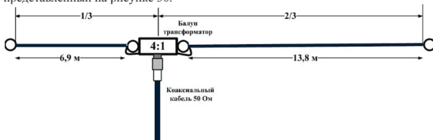
Рисунок 30 – Конструкция Windom антенны
