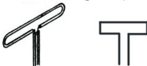
Рисунок 19 – Антенна – петлевой вибратор
