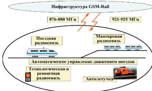
Рисунок 106 – Система радиосвязи GSM-Rail (GSM-R) разработана на основе сотового стандарта GSM
