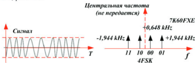
Рисунок 115 – Применяемая в DMR модуляция типа FSK (4-хуровневая частотная манипуляция)
