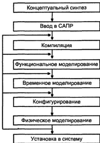
Рис. 9.3. Укрупненная структура алгоритмов автоматизированного проектирования цифровых устройств на основе микросхем программируемой логики
