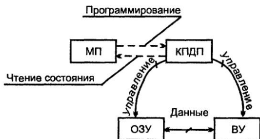
Рис. 6.23. Схема взаимодействия блоков микропроцессорной системы при прямом доступе к памяти
