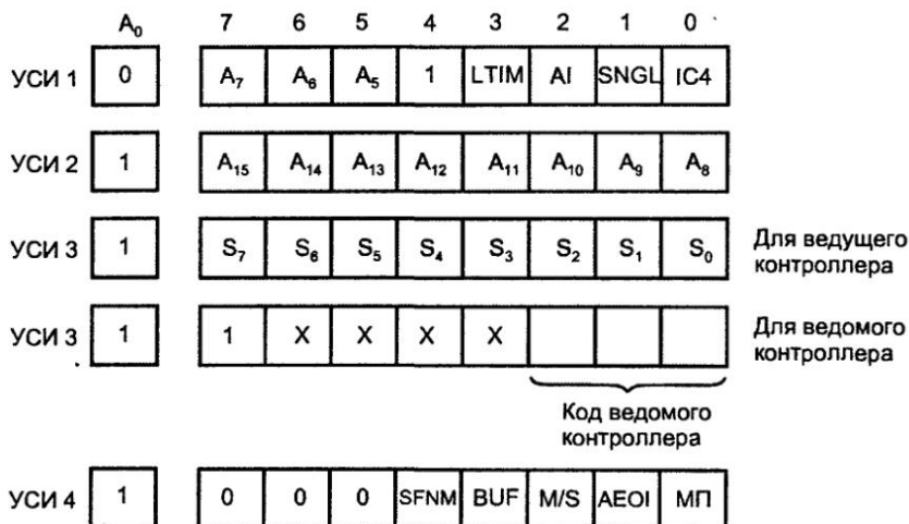
Рис. 6.19. Форматы управляющих слов инициализации программируемого контроллера прерываний
