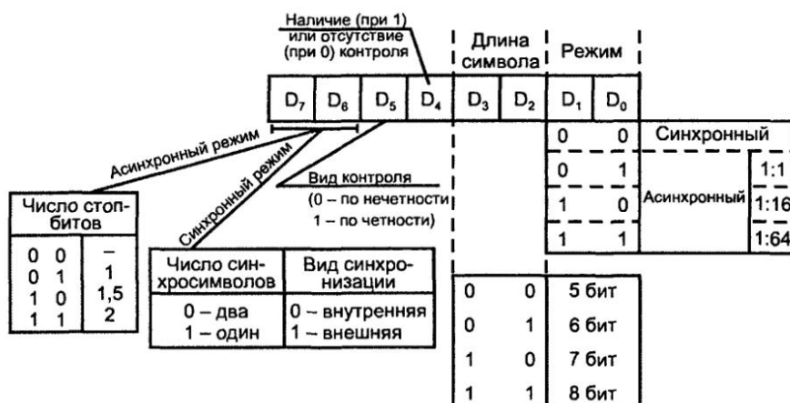
Рис. 6.11. Формат управляющего слова режима программируемого связного адаптера
