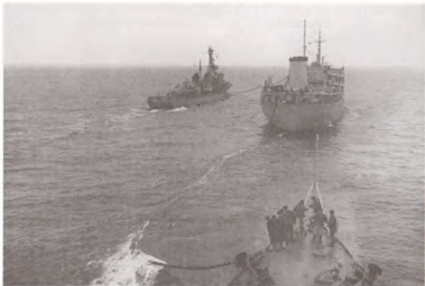
Норвежское море. Передача топлива в открытом море на ходу с танкера на два эсминца
