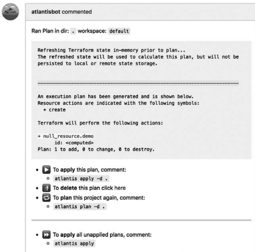
Рис. 10.3. Atlantis умеет автоматически добавлять вывод команды terraform plan в виде комментариев к запросам на включение изменений
