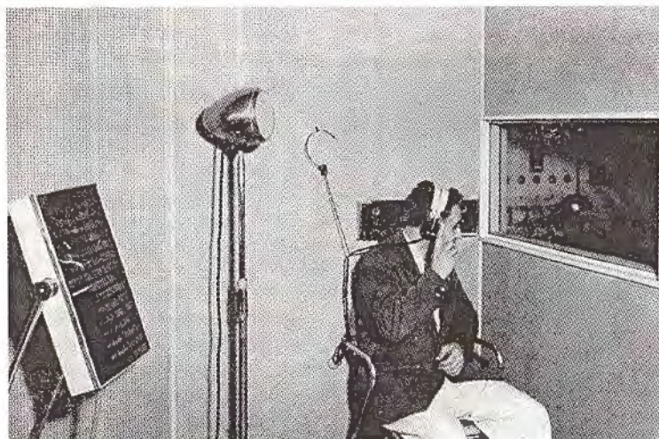
Эксперимент: аудиометрическое исследование в звуконепроницаемой камере.
