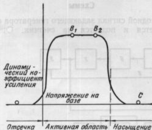
Фиг. 3. Типичная динамическая характеристика включающей схемы плоскостного транзистора.
