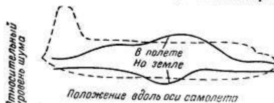
Фиг. 1. Распределение на самолете уровня шума, наводимого на входы усилителей.
