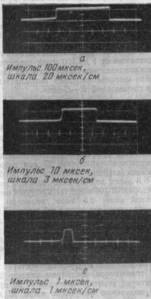
Фиг. 4. Форма выходного импульса одновибратора задержки для длительностей 1, 10, 100 мксек при амплитуде 4,2 в.
