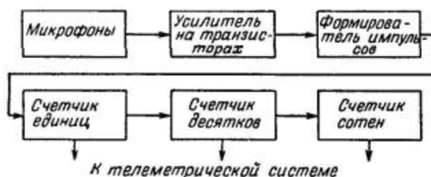
Фиг. 12. Блок-схема счетчика метеоритов.
