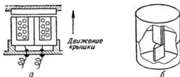
Ф и г. 1. В блоке настройки (а) изменение индуктивности происходит вследствие изменения воздушного зазора магнитопровода. Поворот одной чашки относительно другой в блоке настройки типа D (б) изменяет величину воздушного зазора.
