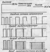
Фиг. 12. Регулировка при различных входных уровнях напряжения сети.
