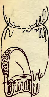
Рис. 67. Обработка низа двух-, трех- слойного рукава
