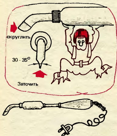
Рис. 38. Измените форму жала паяльника и удлините его шнур
