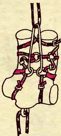
Рис. 219. Испытания прочности страховочной системы для случая падения вниз головой
