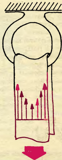
Рис. 241. Лента, продетая в кольцо, при рывке неравномерно нагружается по своей ширине
