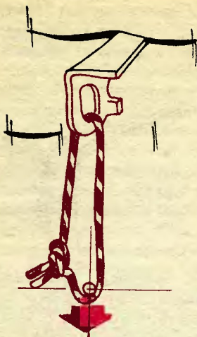
Рис. 237. Вербка продевается в крюк и завязывается узлом проводник
