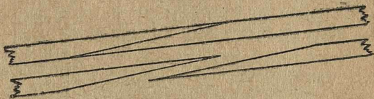
Рис. 136. Склеивание «на ус»
