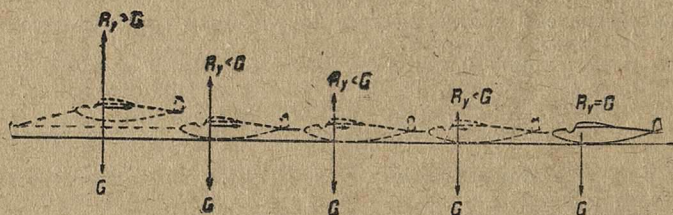
Рис 58. Возрастание подъемной силы и лобового сопротивления по мере нарастания скорости планера на взлете
