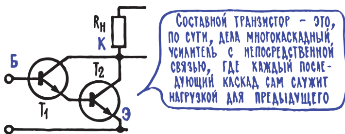
Рис. 12.8. Составной транзистор
