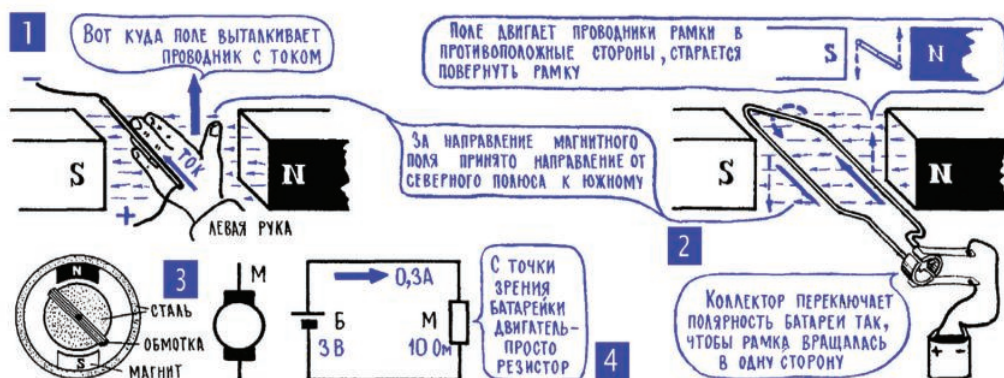
Рис. 5.6. Принцип устройства электродвигателя
