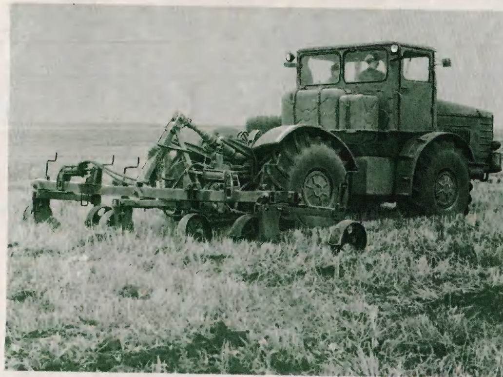
Трактор К-700 с агрегатом плоскорезов АП-7,5 (ширина захвата 7,5 м) на обработке земель, подверженных ветровой эрозии.
