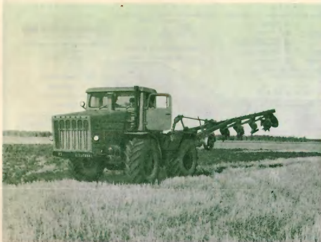
Трактор «Кировец» К-700 (мощность двигателя 220 л.с.). Предназначен для работ с различными сельскохозяйственными машинами и орудиями на пашоте, севе и уборке урожая. Может буксировать прицеп с грузом до 50 т
