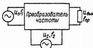
Рис. 6.10. Структурная схема преобразователя частоты
