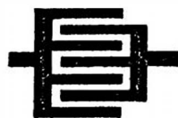
Рис. 9.34. Гребенчатый конденсатор
