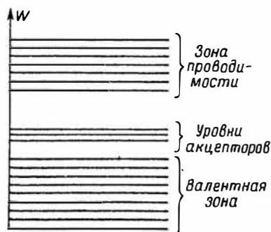
Рис. 1.11. Зонная диаграмма полупроводника p-типа
