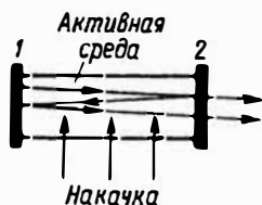
Рис. 12.1. Принцип устройства лазера
