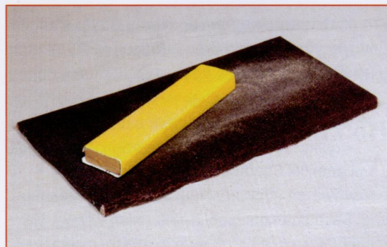
Планшет и брусок для обработки торцов заготовок
