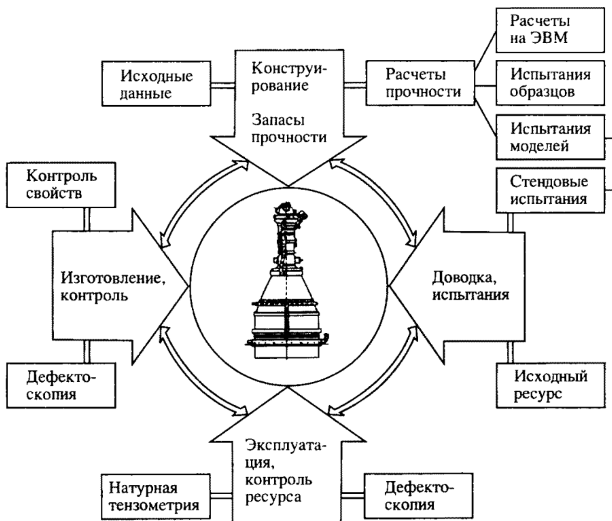
Рис. 11.1. Схема решения основных задач при создании ЖРД
