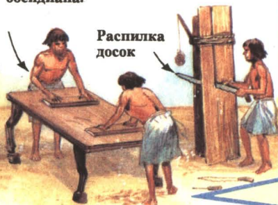
Полирование древесины с помощью каменного песка
