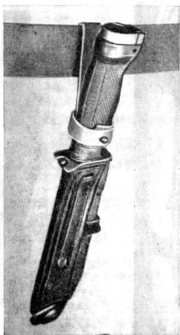
Рис. 9. Крепление НРС на подвеске при ношении на пояском ремне
