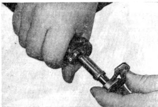
Рис. 42. Вставление ствола с патроном в ствольную коробку
