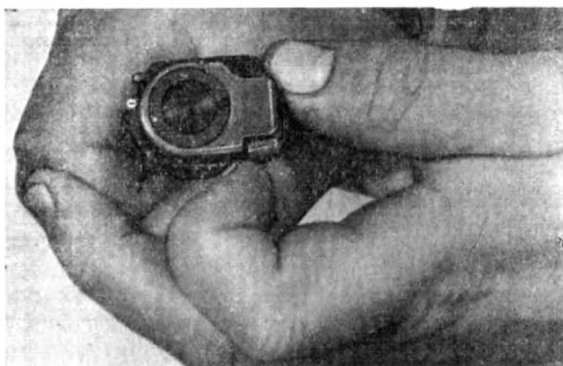
Рис. 41. Открывание флажка пальцами одной руки
