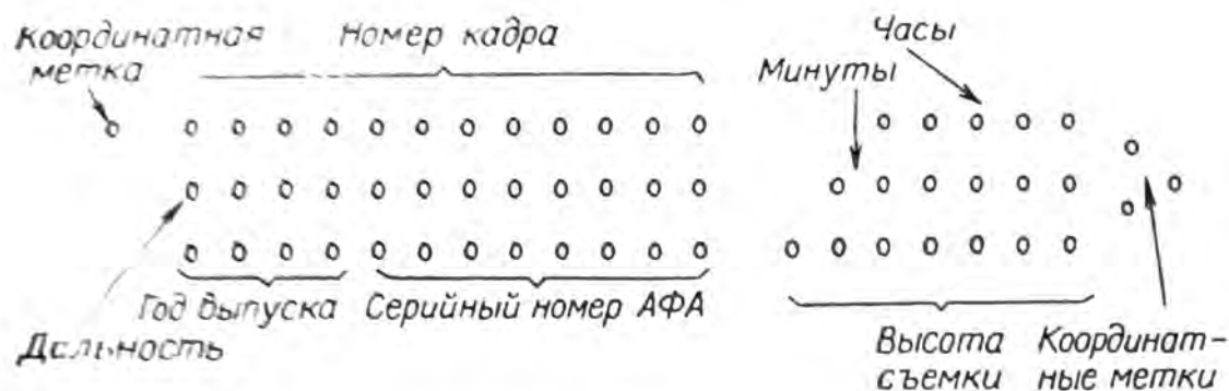
Рис. 61. Пример содержания кодовой матрицы при регистрации отдельных полетных данных, характеристик аппаратуры и элементов внешнего ориентирования аэроснимков
