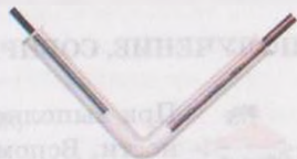
Рис. 62. Устройство для наблюдения коррозии цинка в контакте с медью
