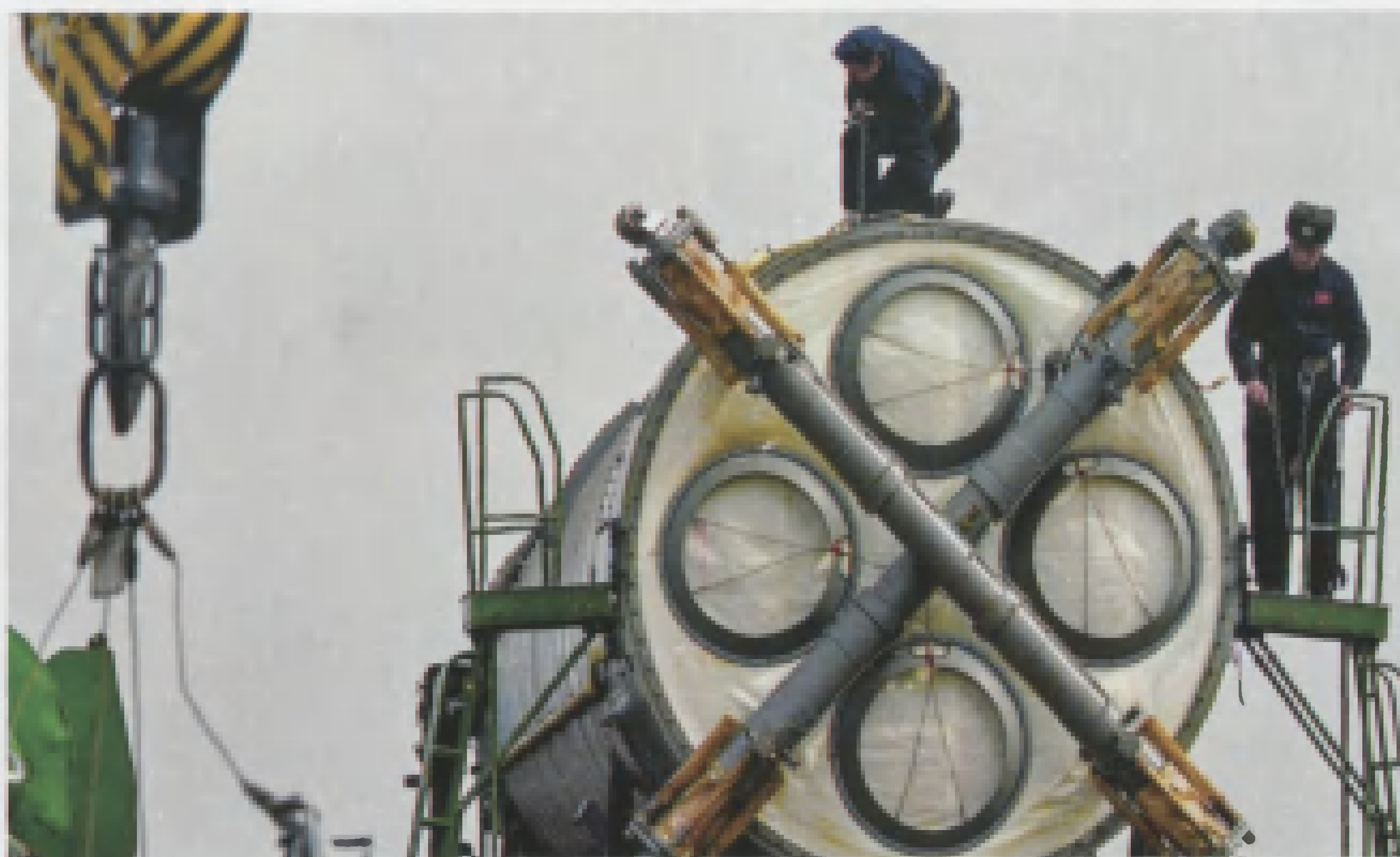
Україна виконувала свої зобов'язання. Ракета РС-18 (SS-19) вилучена з ШПУ. Розрахунок групи технічної ракетної бази готує її до транспортування на технічну позицію 46-ї ракетної дивізії
