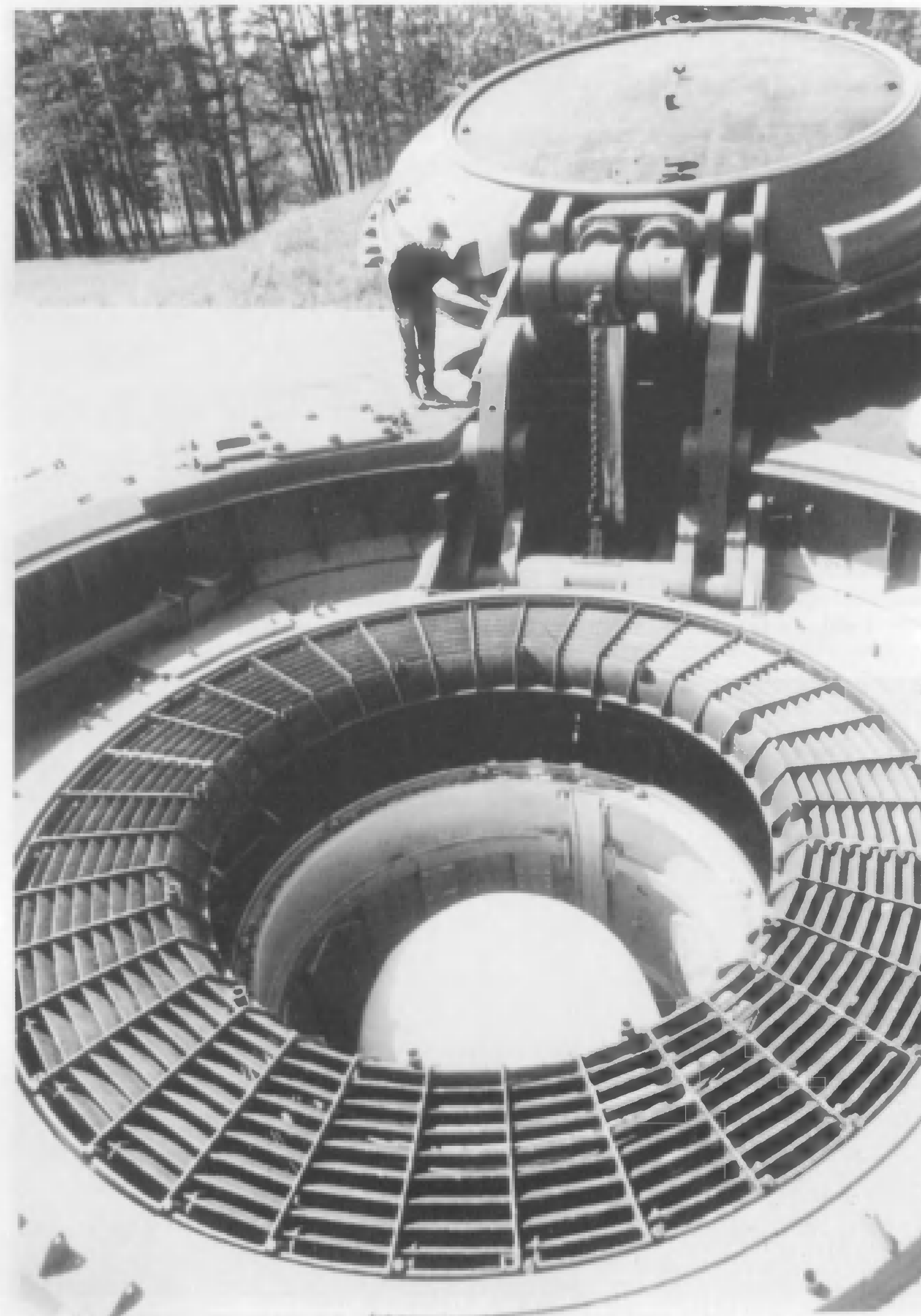
МБР с ядерной головной частью в ШПУ. Проводится подготовка к отстыковке ЯГЧ
