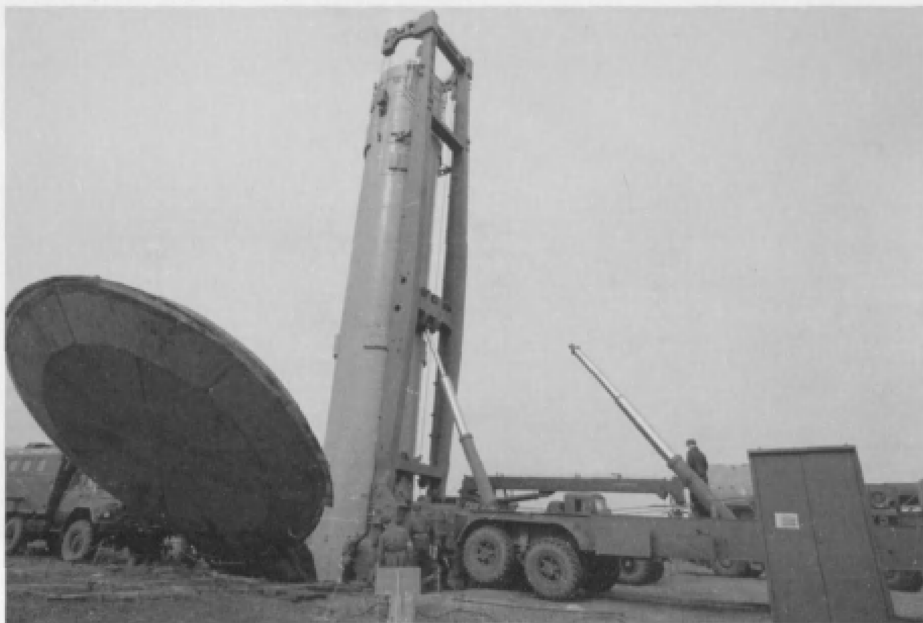
После слива компонентов РТ контейнер с ракетой РС-18 (SS-19) извлекается из ШП
