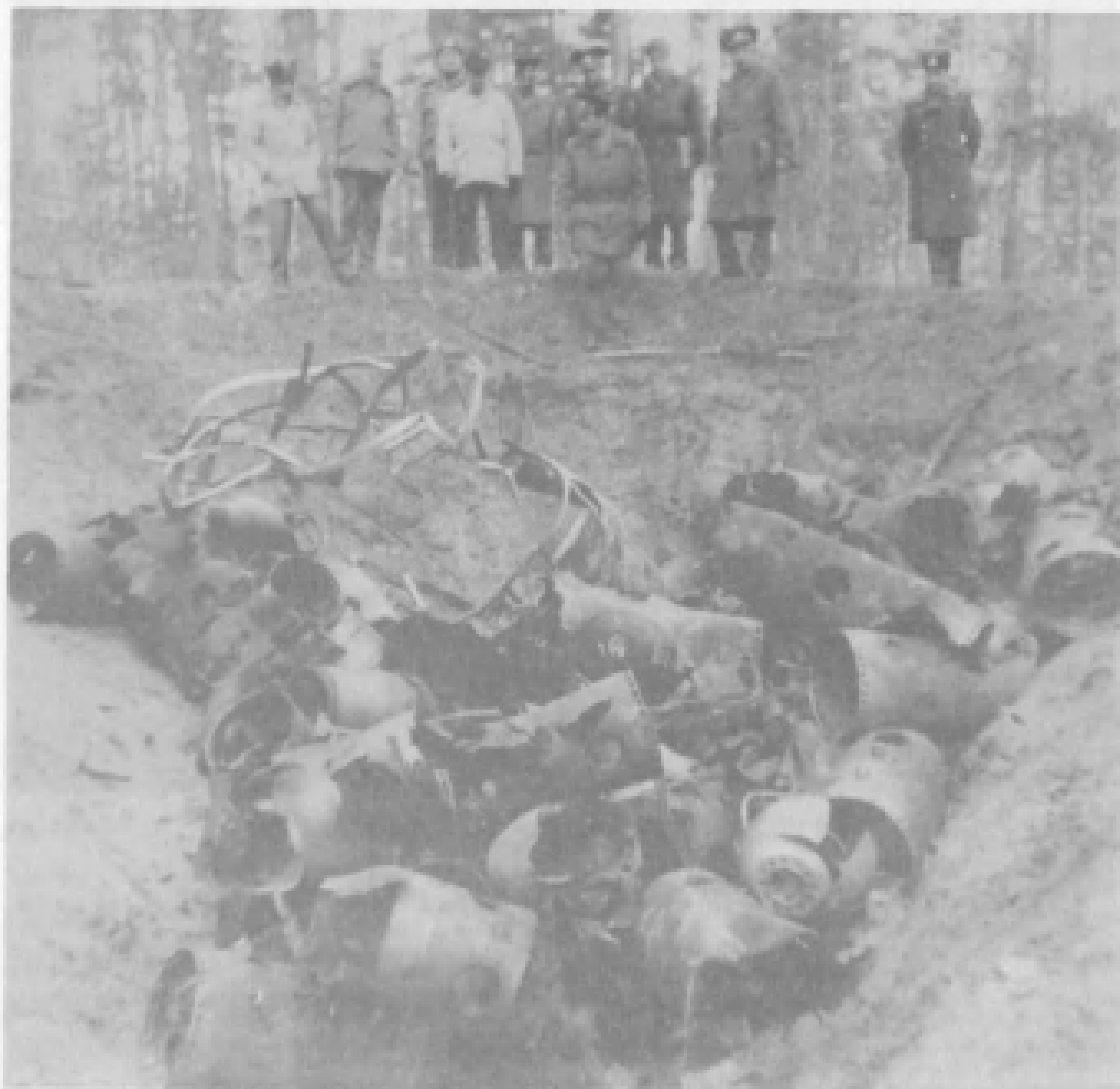
Склаживание уничтоженных корпусов изделий СН-40 перед засыпкой их грунтом
