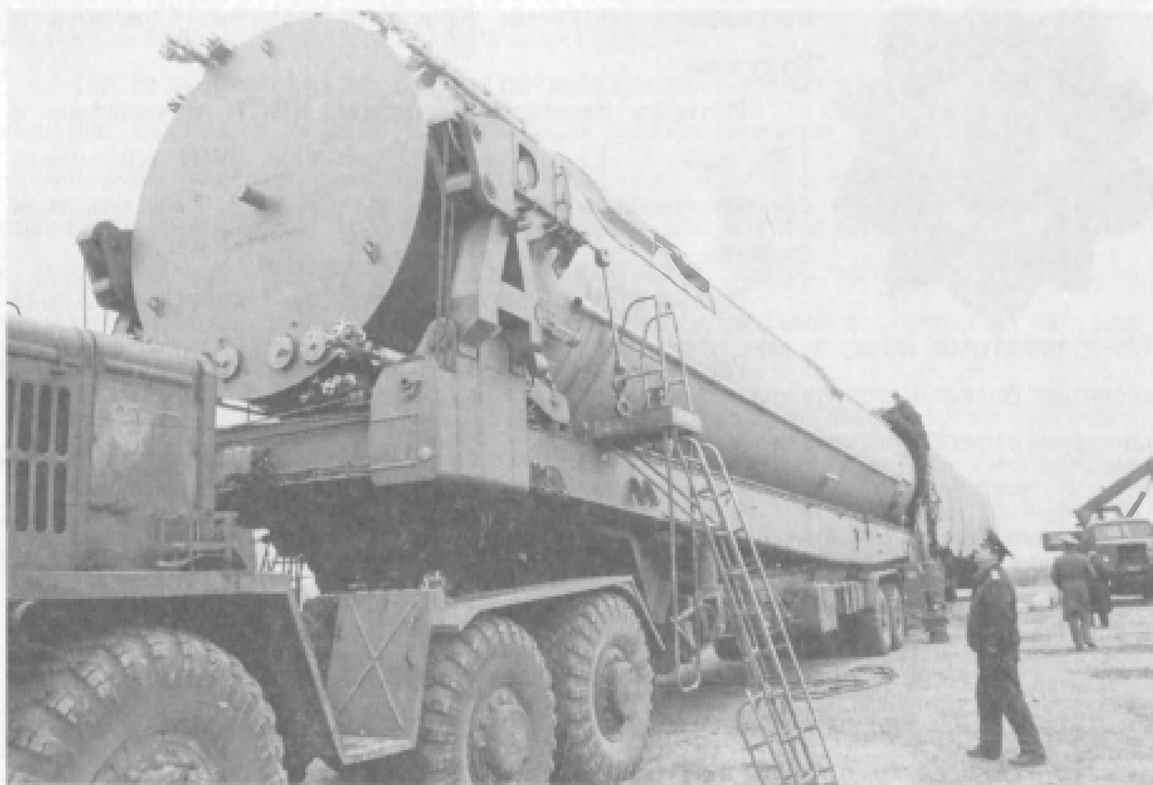
МБР после извлечения из ШПУ перегружается с установщика на транспортный агрегат
