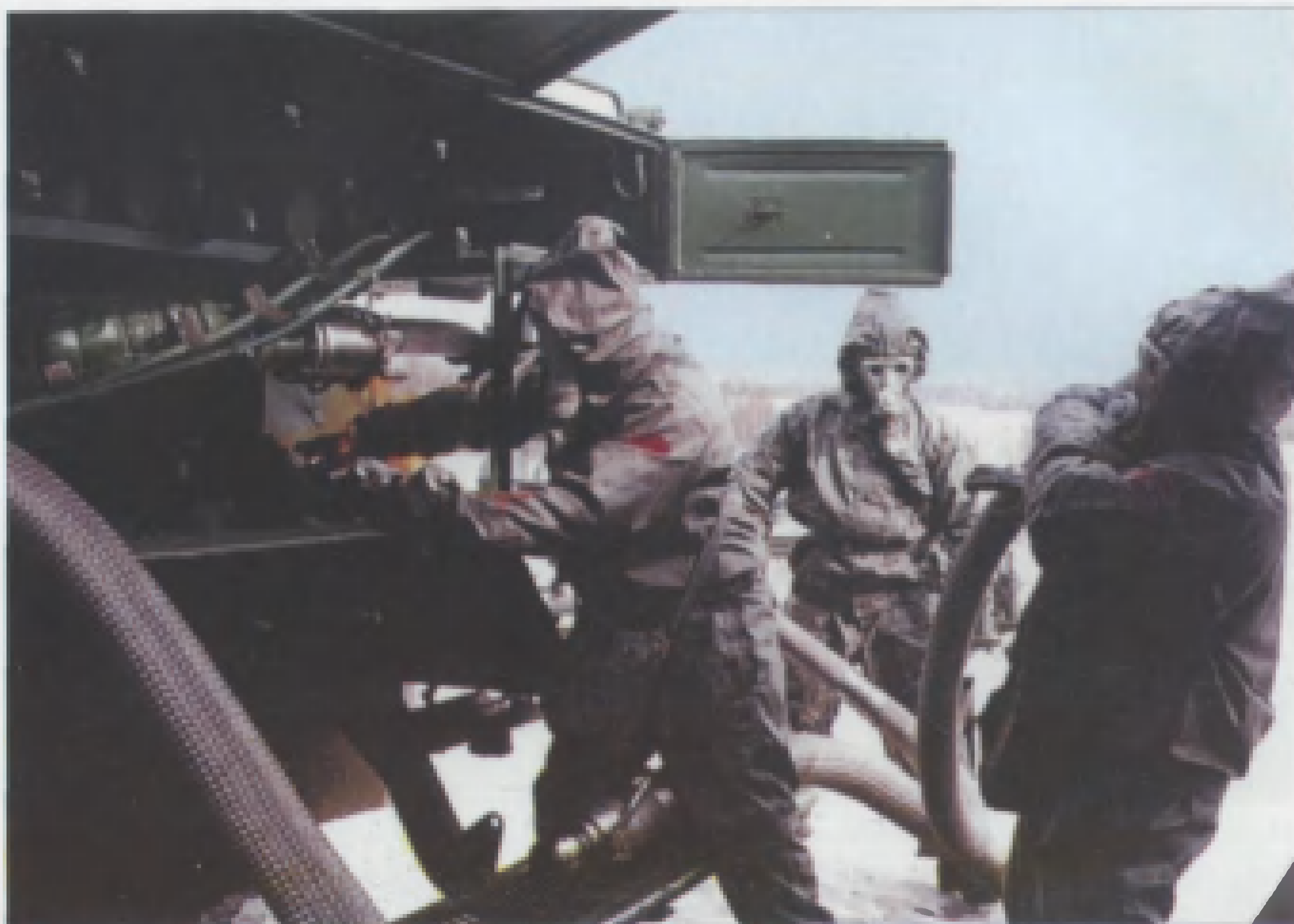
Боевой расчет группы заправки выполняет работы на ШПУ по сливу топлива с ракеты
