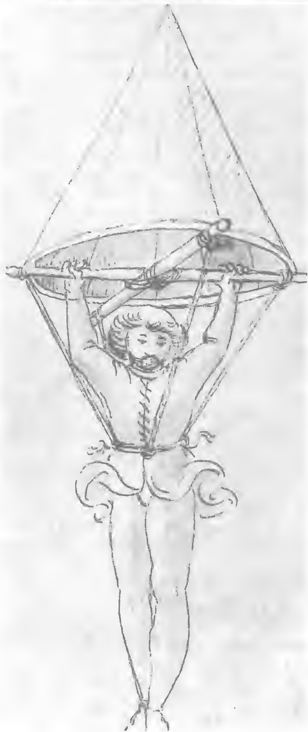
Конический парашют из ткани. Рисунок из альбома итальянского инженера 1480 г.
