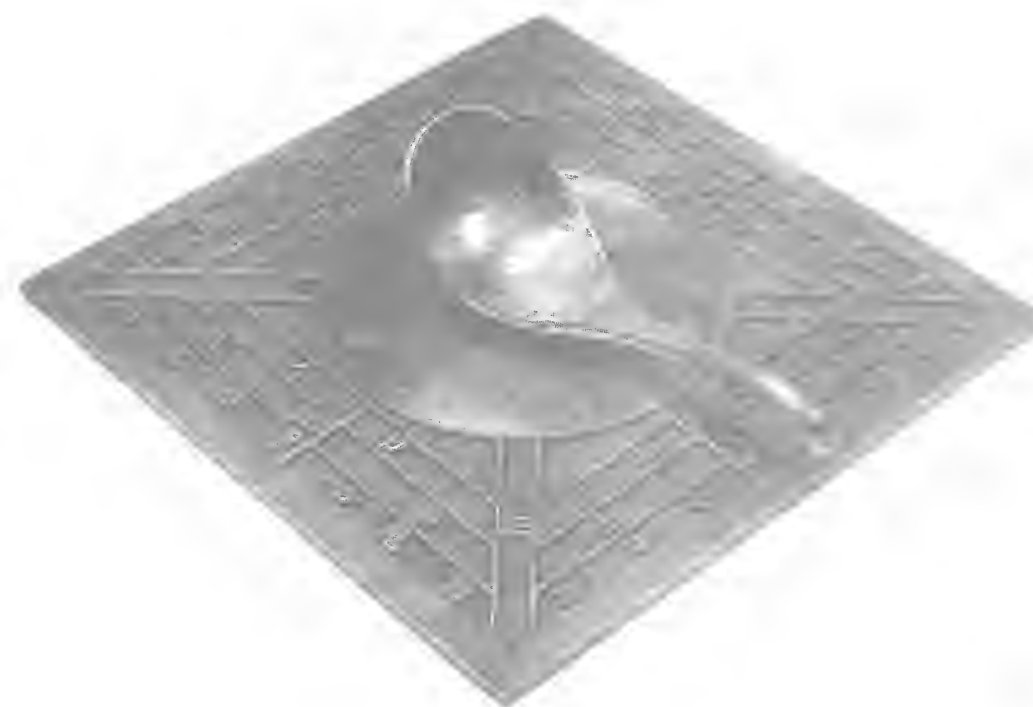
Реконструкция синана — древнейшей формы китайского компаса из Научного центра Онтарио, Торонто. Ковш, указывающий южное направление, вырезан из магнетита и вращается на полированной бронзовой пластине.
