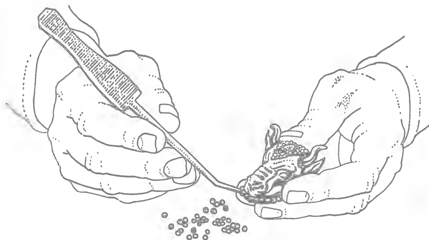
Сложный процесс грануляции. Показано, как мельчайшие золотые шарики приклеивают пастой, приготовленной из рыбного клея, гидроокиси меда и воды, нанесенной на поверхность металла.
