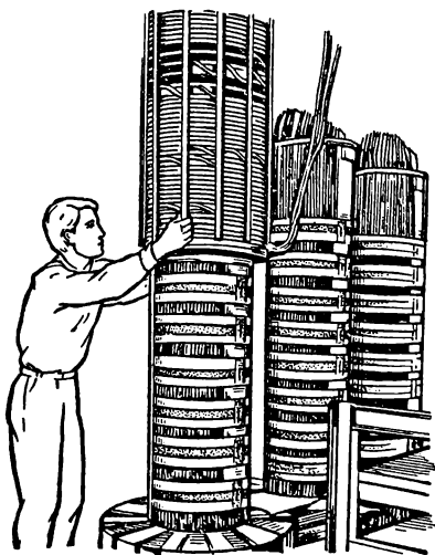
Рис. 98. Насадка обмотки трансформатора мощностью 6300 кВ·А
