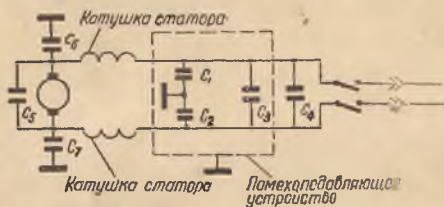
Рис. 22а. Электрическая схема кофемолки «Страуме»
