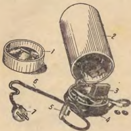
Рис. 22. Устройство кофемолки «Страуме»:
