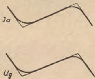
Рис. 101. Форма пилообразного тока при малой полосе пропускания
