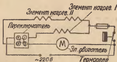
Рис. 15а. Электрическая схема аппарата для сушки волос «Улыбка»
