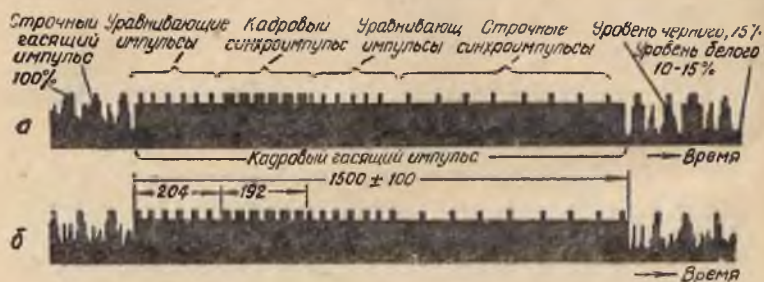
Рис. 92. Полный телевизионный сигнал:
