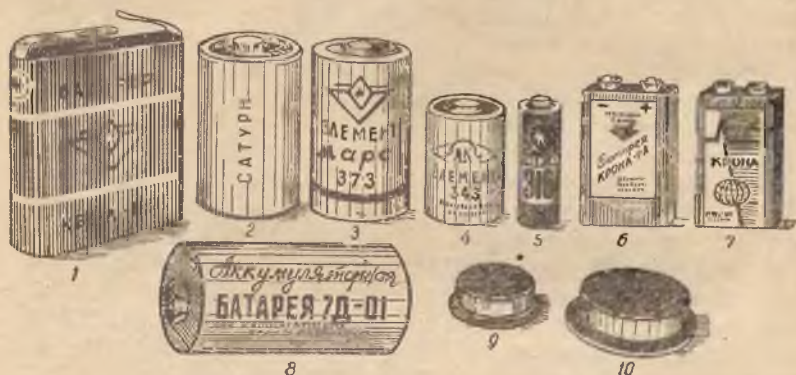
Рис. 80. Батареи и аккумуляторы для питания транзисторных приемников:
