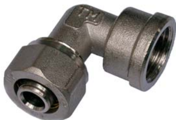
Угольник с внутренней резьбой (переход на трубную арматуру) 16×1/2; 20×1/2; 20×3/4; 26×1; 32×1
