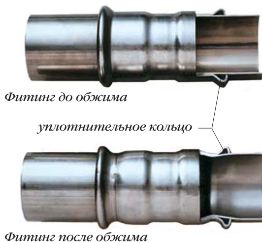
Рис. 45. Обжим стальных труб пресс-фитингами
