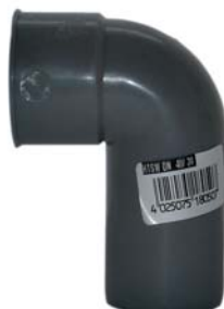
Отвод на сифон: угол — 90° D трубы — 32; 40; 50 мм D на сифон — 32; 40 мм
