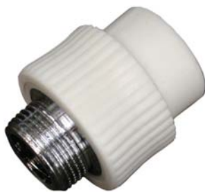
Муфта с наружной резьбой (переход на трубную арматуру) 16×1/2; 20×1/2; 20×3/4; 25×1; 32×1
