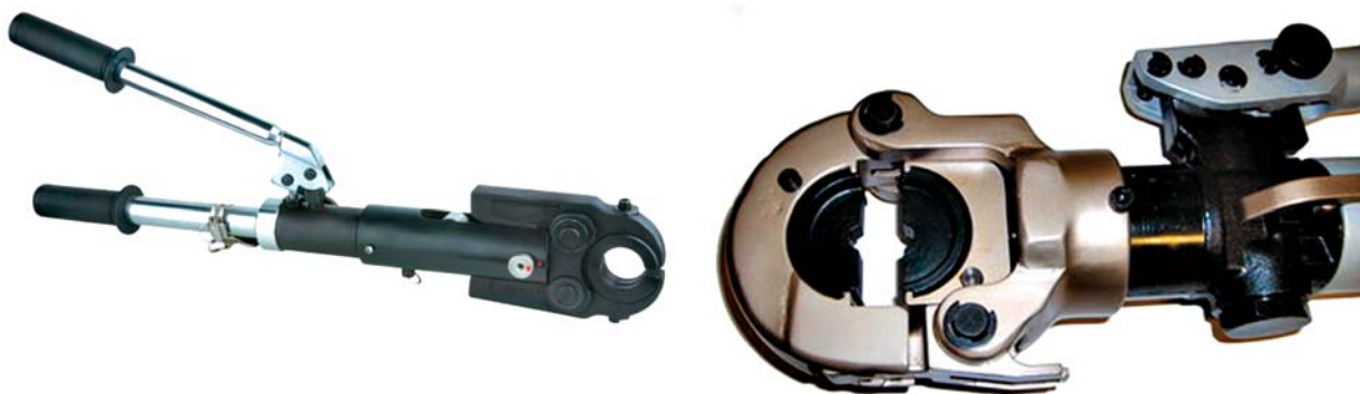
Рис. 18. Ручные гидравлические пресс-клещи
