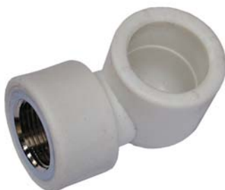
Угольник с внутренней резьбой (переход на трубную арматуру) 16×1/2; 20×1/2; 20×3/4; 25×1; 32×1
