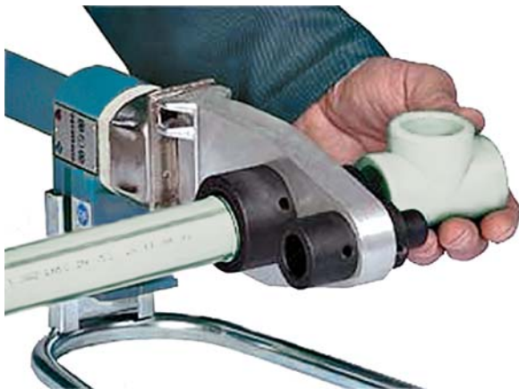
Поместить соединяемые детали на нагревательные элементы
