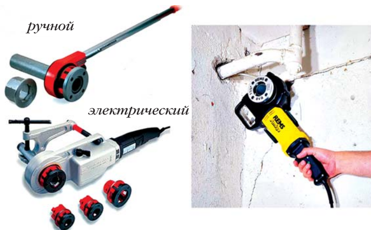
Рис. 48. Инструмент для нарезания резьбы — клупп
