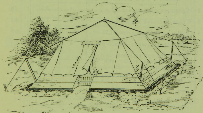
Р и с. 6. Лагерная красноармейская палатка, установленная на гнезда с откосами
