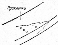
Рис. 89. Один из способов починки лыжи при продольной трещине или сколе.
