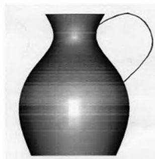
Рис. 5. Объемное тело кувшина с направляющей линией для образования ручки
