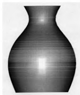
Рис. 4. Объемное изображение тела кувшина, созданное вращением вокруг вертикальной оси
