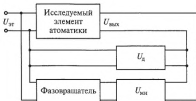
Рис. 9.4. Структурная схема фазочувствительного вольтметра
