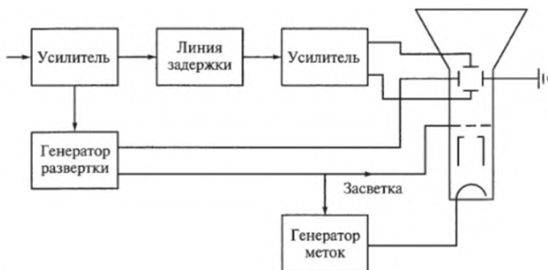
Рис. 10.1. Структурная схема осциллографа, работающего в режиме ждущей развертки
