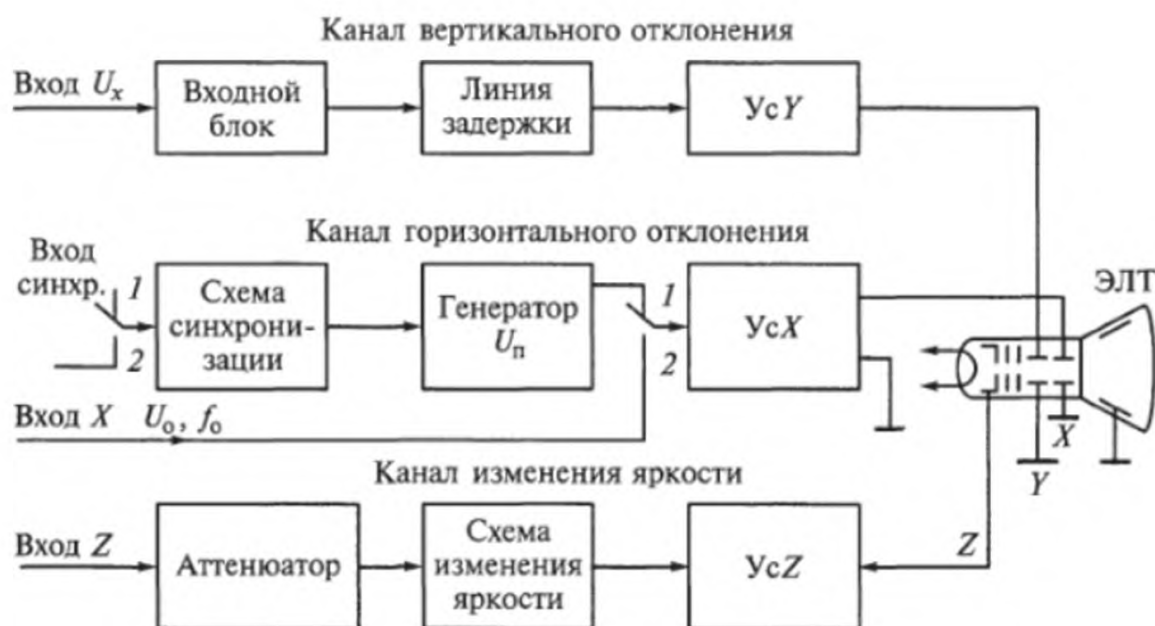
Рис. 12.5. Структурная схема однолучевого осциллографа
