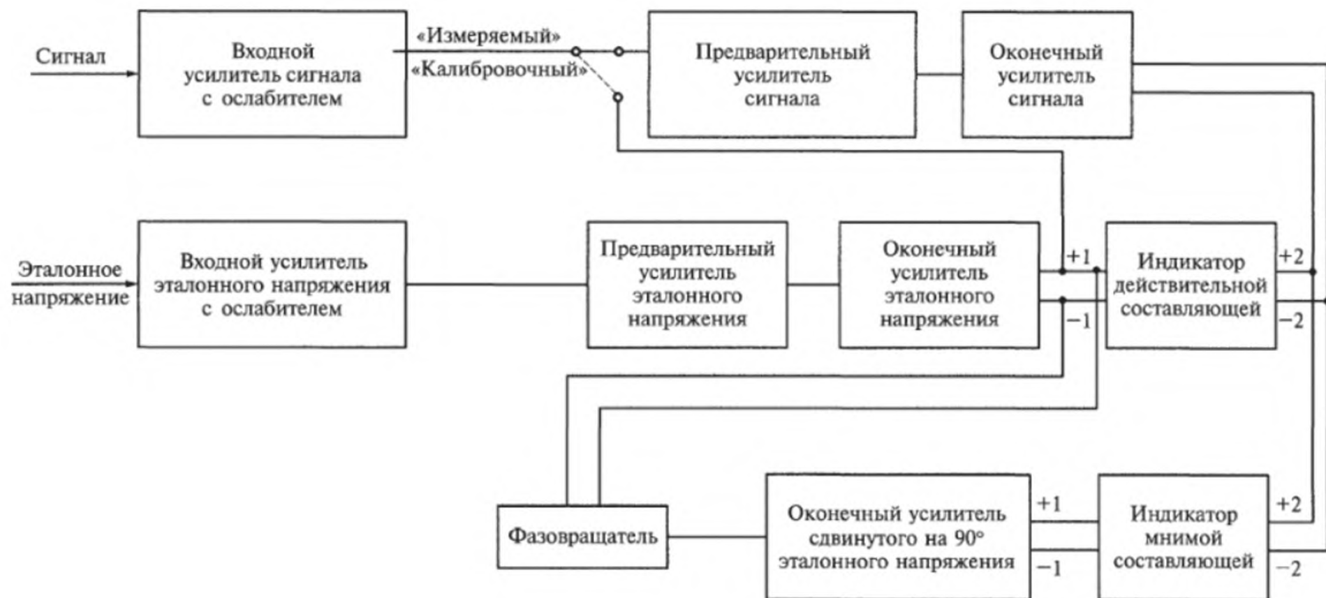
Рис. 9.3. Блок-схема фазочувствительного вольтметра
