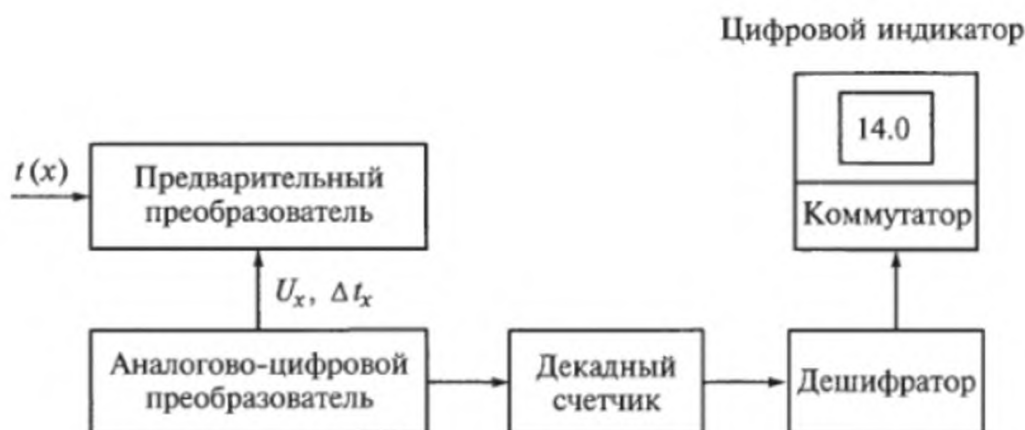
Рис. 13.1. Структурная схема ЦИП
