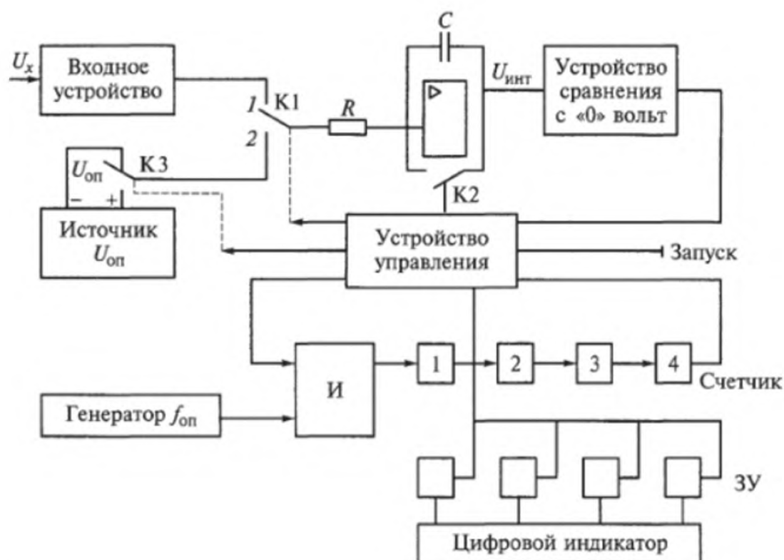
Рис. 13.5. Функциональная схема цифрового вольтметра для измерения среднего значения напряжения
