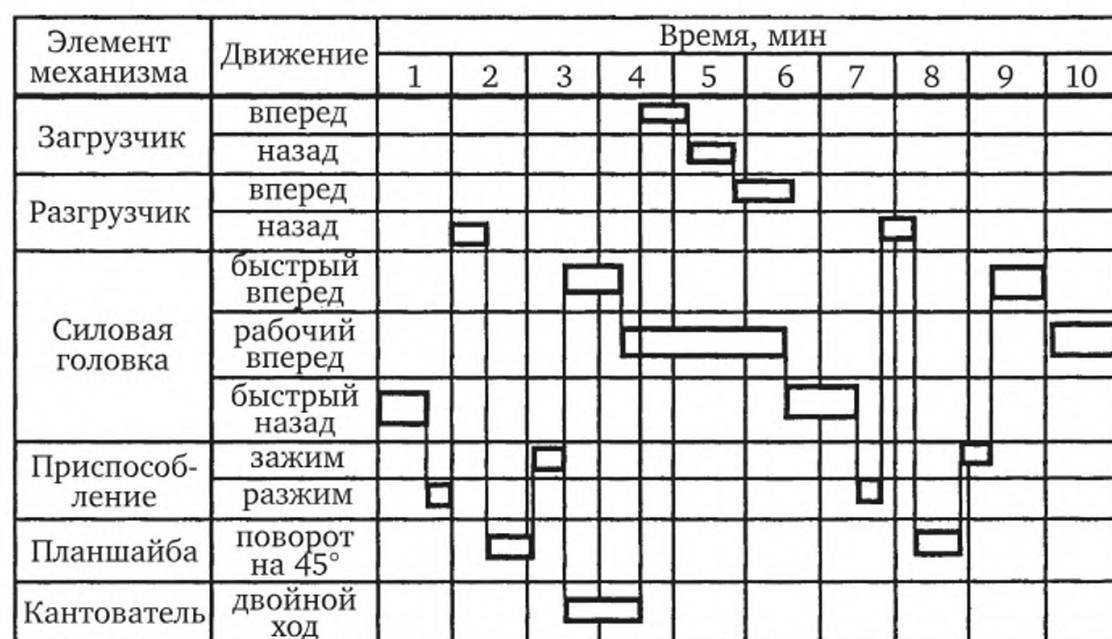
Рис. 15.9. Задание исходной технологической информации о рабочем цикле с помощью циклограммы включений
