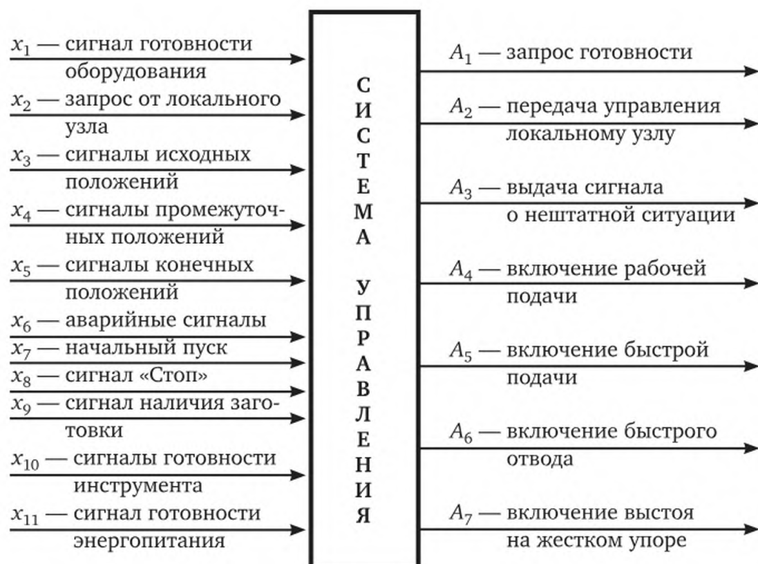
Рис. 15.10. Пример входных и выходных сигналов системы управления автоматическим циклом технологического оборудования
