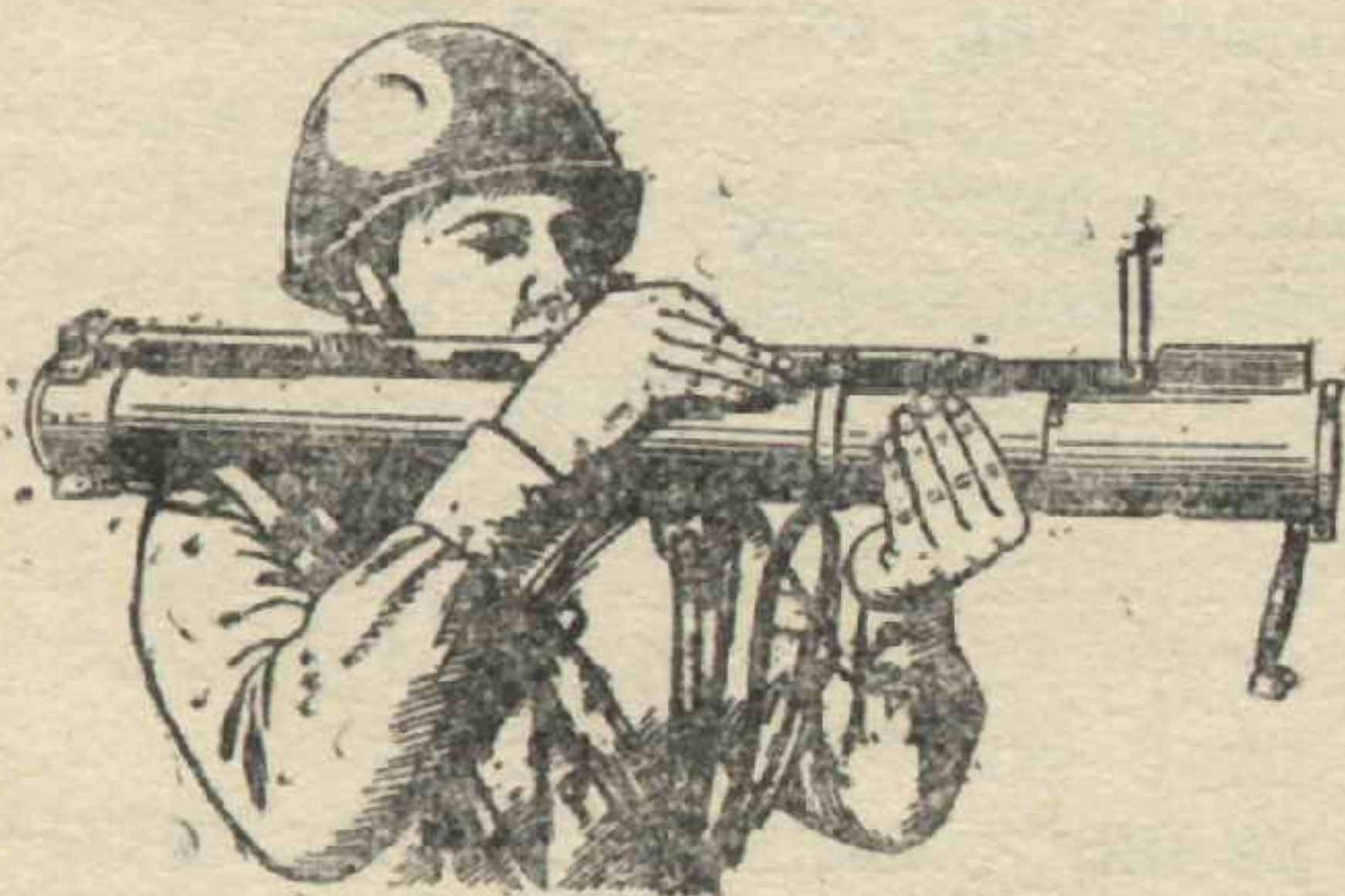
Рис. 24. Взведение ударно-спускового механизма
