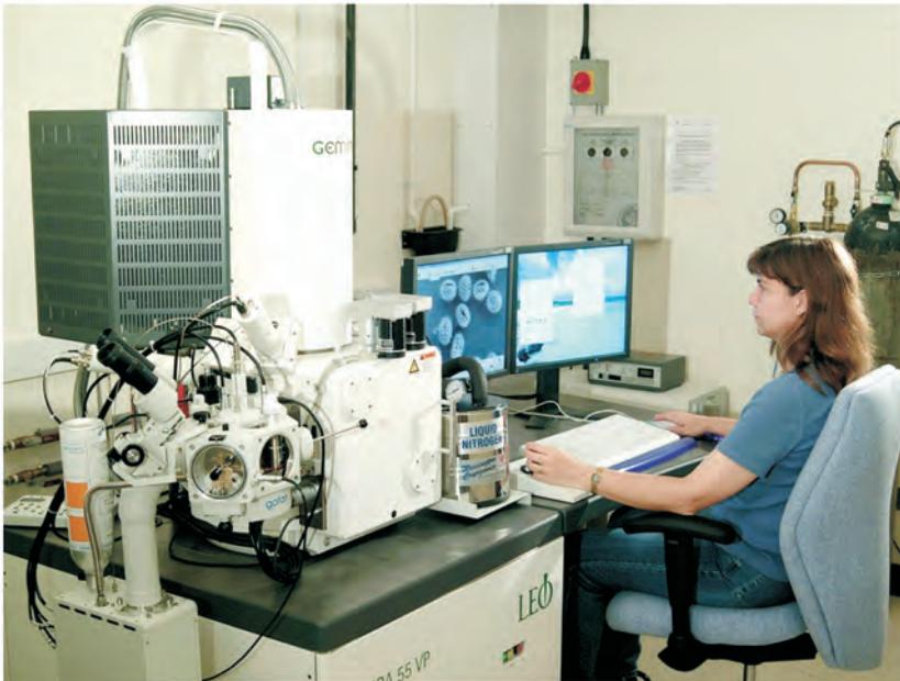
Рис. 9.49. Сканирующий электронный микроскоп. Образец сканируют пучком электронов, фокусирующимся на препарате электромагнитными катушками, исполняющими роль линз. Детектор измеряет количество рассеянных или испущенных электронов при последовательной бомбардировке каждой точки поверхности образца и контролирует интенсивность точек на изображении, формирующемся на видеоэкране. SEM позволяет получать удивительные изображения трехмерных объектов с большой глубиной фокуса и разрешением от 3 нм до 20 нм в зависимости от прибора. (Фотография приведена с любезного разрешения Andrew Davies.)
