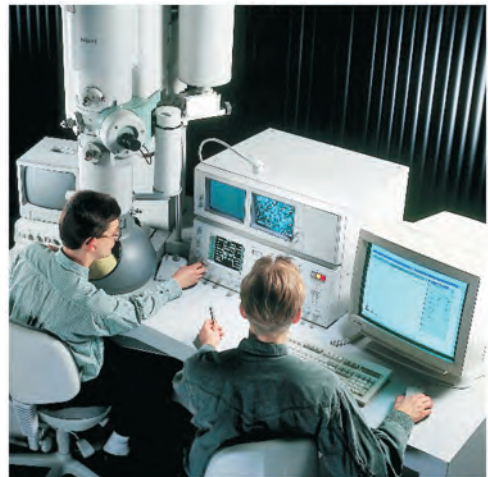
Рис. 9.42. Принципиальное строение светового микроскопа и трансмиссионного электронного микроскопа. На данном рисунке отмечено сходство внутреннего устройства микроскопов. Стеклянным линзам светового микроскопа в электронном микроскопе соответствуют магнитные катушки. В электронном микроскопе необходимо, чтобы образец находился в вакууме. На фотографии показан рабочий трансмиссионный микроскоп. (Фотография приведена с юбезного разрешения FEI Company Ltd.)
