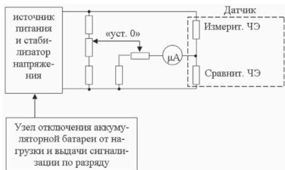
Рис.2.37. Функциональная схема сигнализатора СТХ-5А
