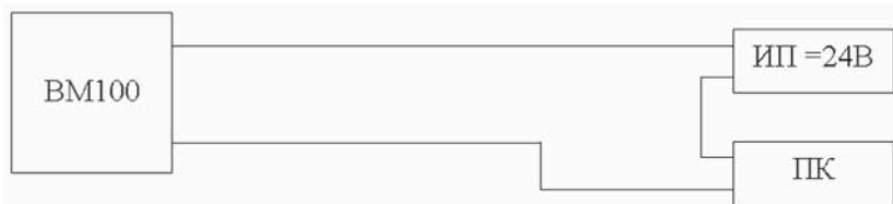
Рис. 2.76. Схема обвязки BM100 (пассивный токовый выход): BM100 - уровнемер, ИП = 24 В - источник питания = 24 В (30 мА), ПК - показывающий прибор или регистратор с входом 4-20 мА
