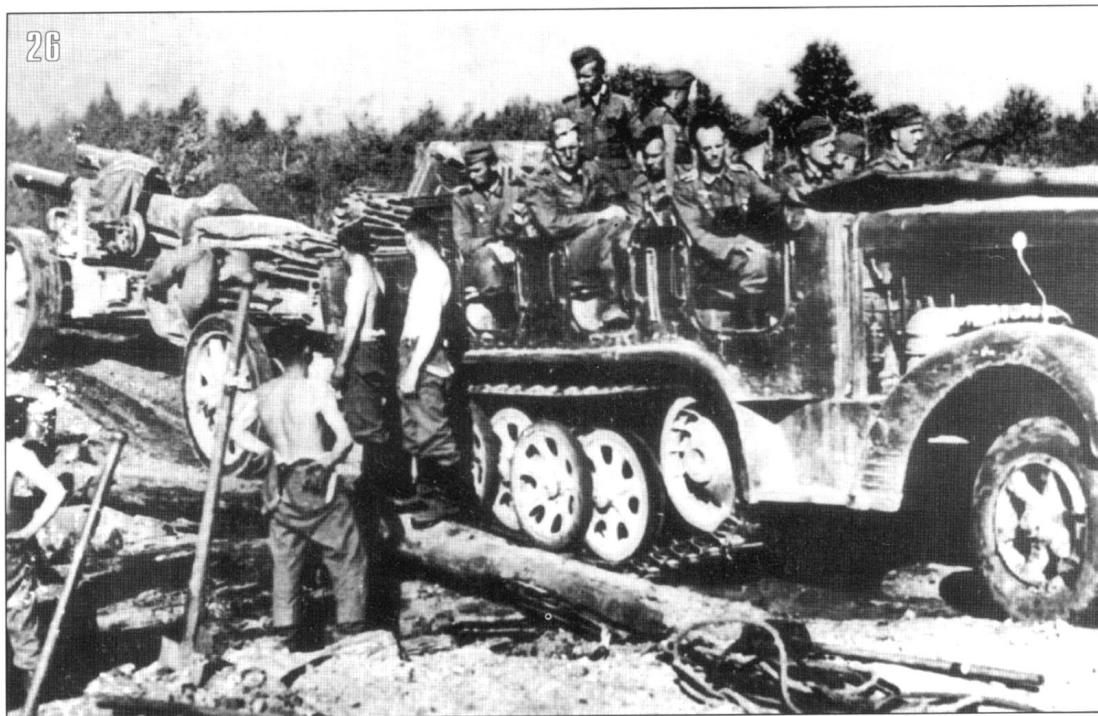
26. Германская артиллерия подтягивается к советской границе. На фотографии виден 8-тонный полугусеничный тягач Sd.Kfz.7 и 150-мм орудие. Группа армий "Центр", июнь 1941 года (АВЛ).
