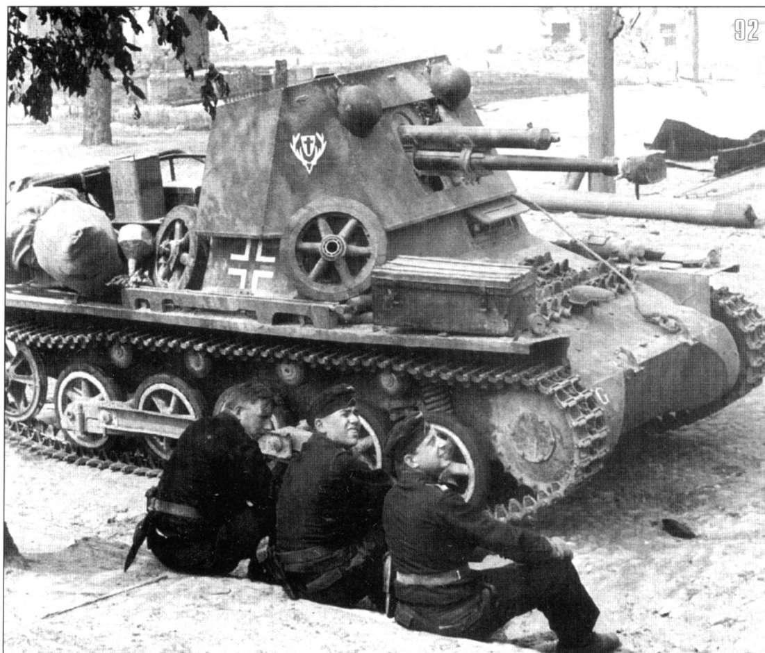
92. Немецкие 47-мм САУ истребители танков Panzerjaeger I из состава 521-го танкоистребительного дивизиона (Panzerjaeger - Abteilung 521). Белоруссия, 2-я танковая группа вермахта, июль 1941 года (АВЛ).
