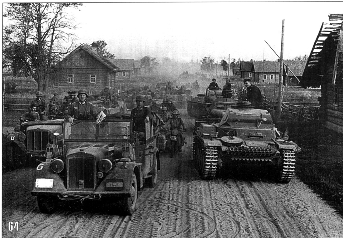
64. На марше соединения 3-й танковой дивизии вермахта. Видна штабная машина Horch-901 (Kfz.15) и легкий танк Pz.Kpfw.II. Группа армий "Центр", июнь 1941 года (АВЛ).
