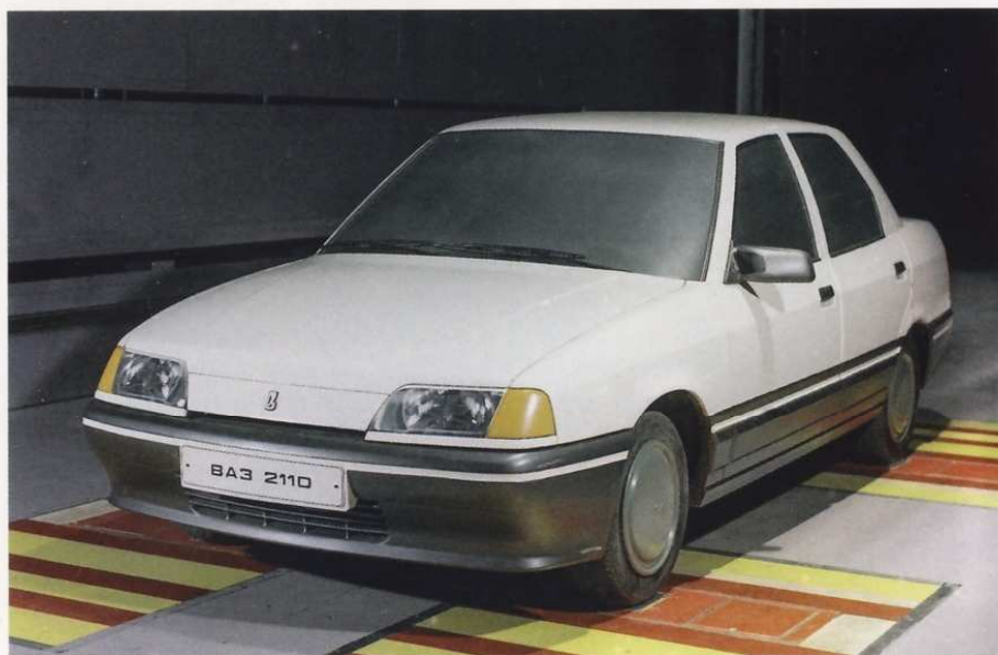
Деревянный макет серии «100» в аэродинамической трубе Дмитровского автополигона НАМИ
