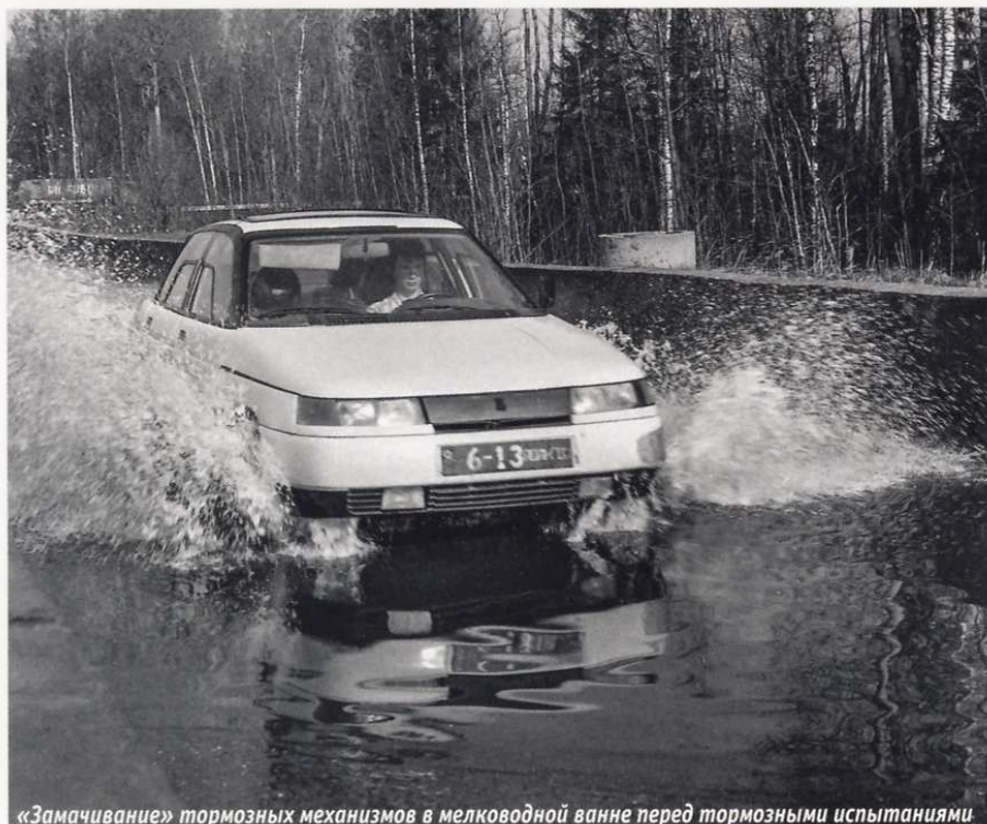
«Замачивание» тормозных механизмов в мелководной ванне перед тормозными испытаниями
