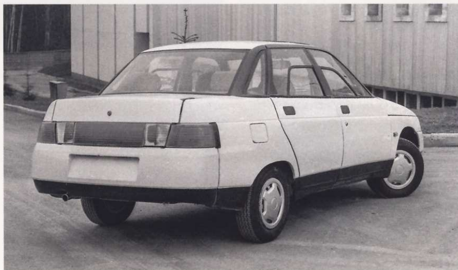
На ранних образцах ВАЗ-2110 «двухсотой» серии хорошо заметны маленькие форточки-«стограммовки»
