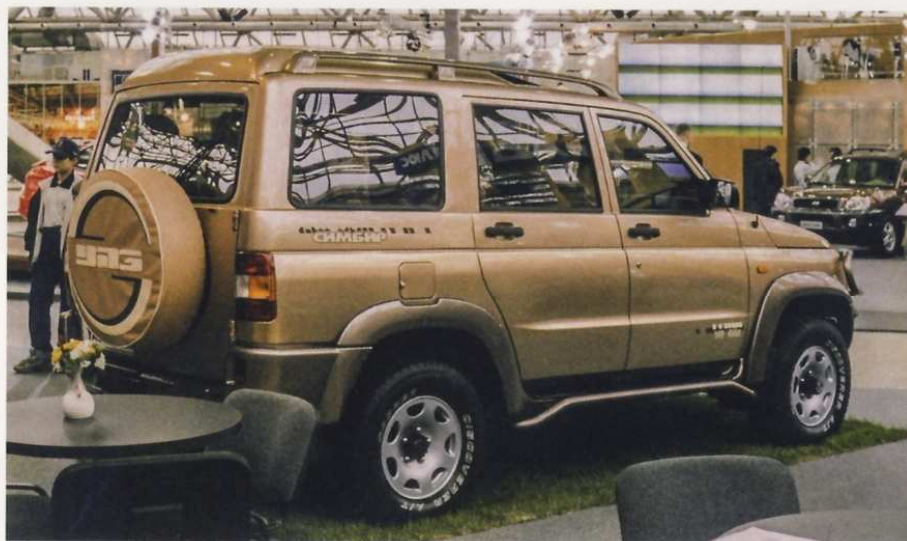
В таком ракурсе хорошо виден выступ на крыше, сделанный для того, чтобы расположить третий ряд сидений по ходу движения
