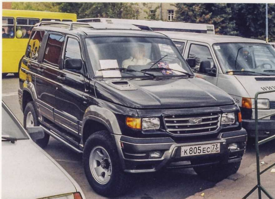
В таком ракурсе хорошо виден выступ на крыше, сделанный для того, чтобы расположить третий ряд сидений по ходу движения
