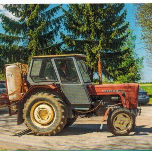
Трактор С-360, модификация модели С-330, производившийся в 1976–1994 годах.
