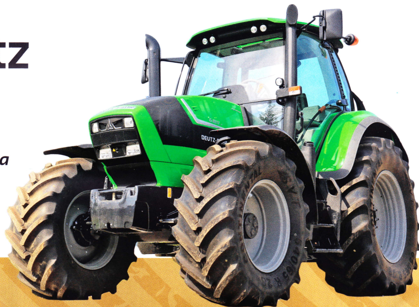
Кормоуборочный трактор Deutz-Fahr 6180 мощностью 165 л. с.
