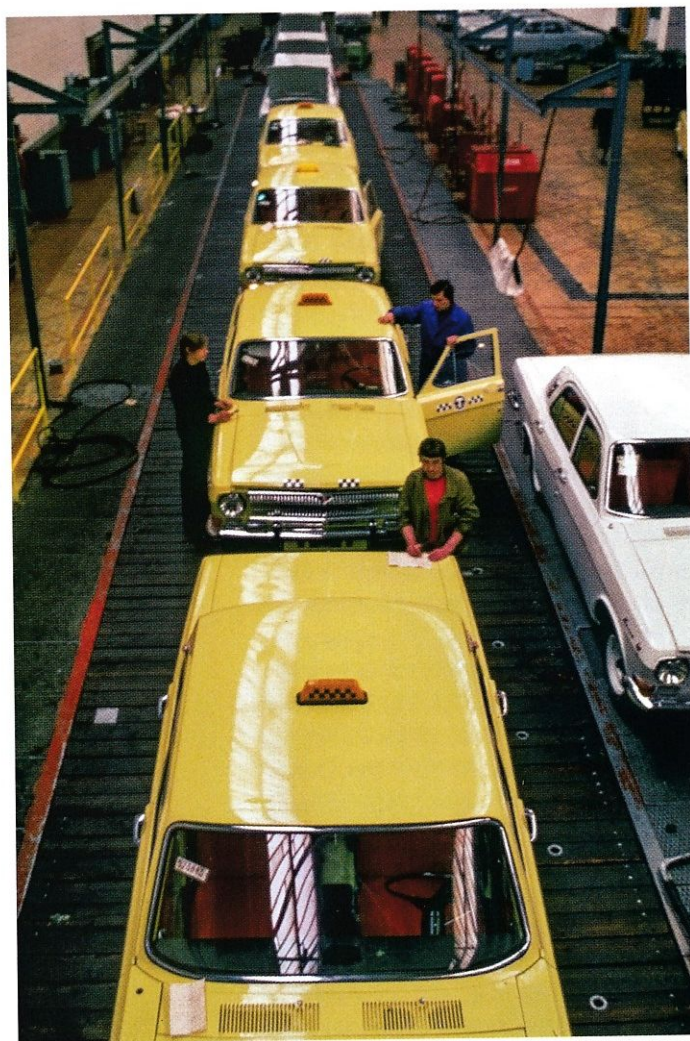
Конвейерная линия для ремонта автомобилей-такси
