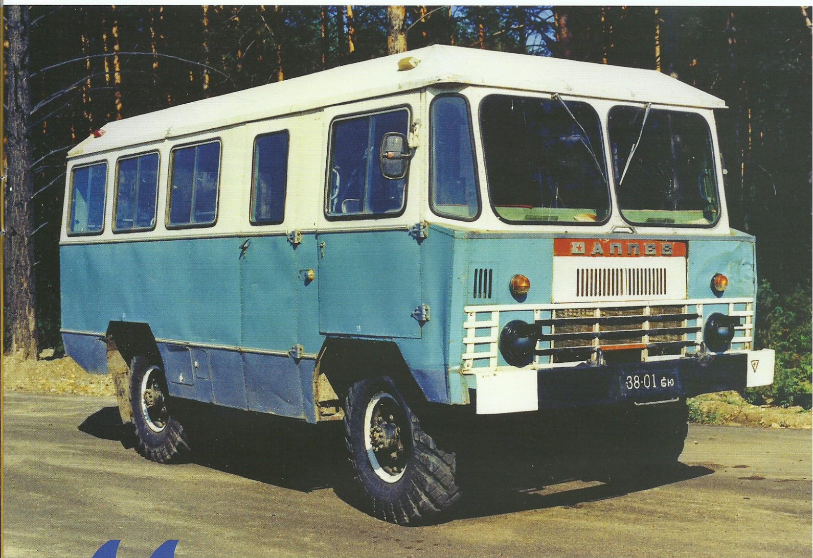
➤ Армейский автобус повышенной проходимости АПП-66
