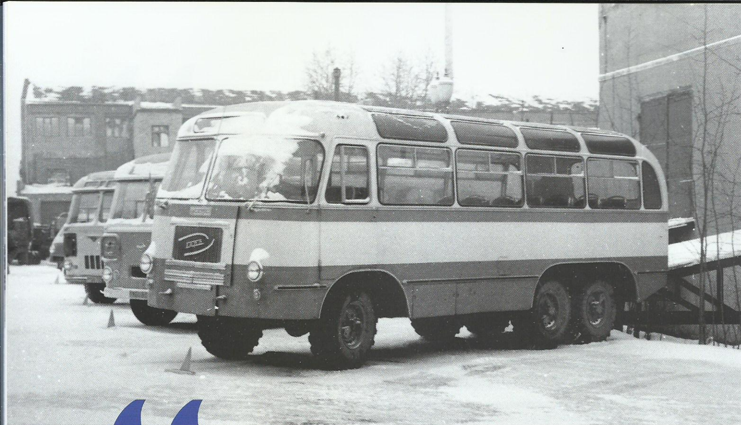
⚡ Автобус повышенной проходимости Тосно-ГАРО на шасси ЗИЛ-157К
