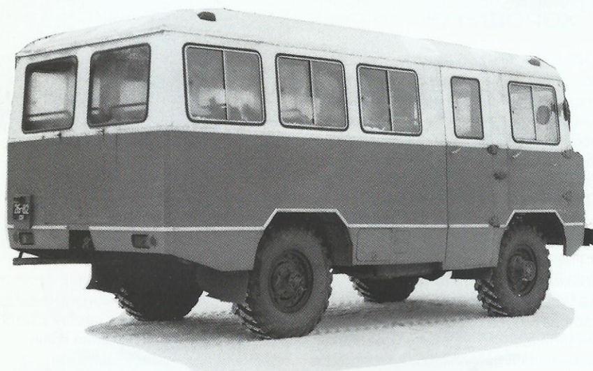
➤ Автобус АПП-66, построенный в Воронеже и проходивший приемочные испытания
