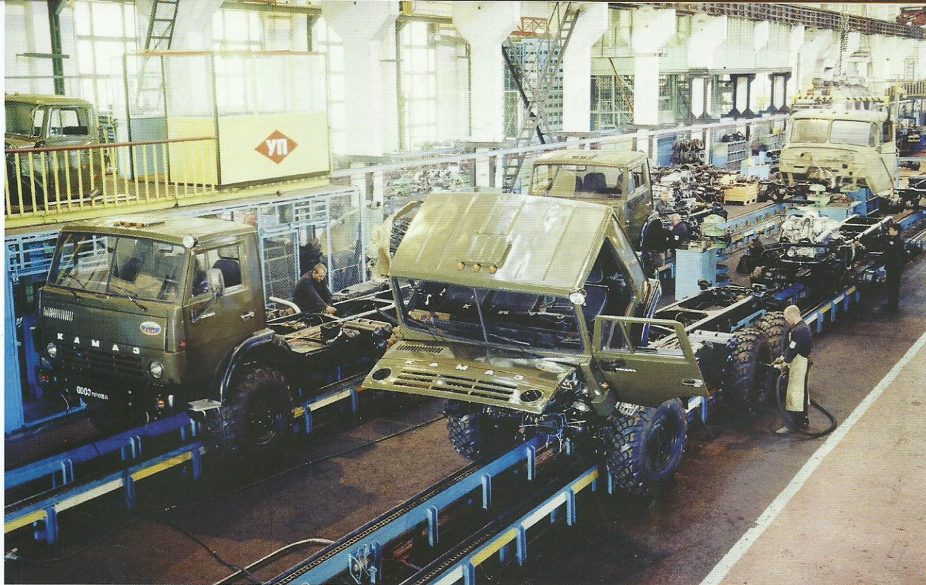
⚡ Капитальный ремонт военной автомобильной техники поточным методом
