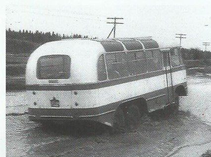
⚡ Автобус Тосно-ГАРО на испытаниях в условиях бездорожья
