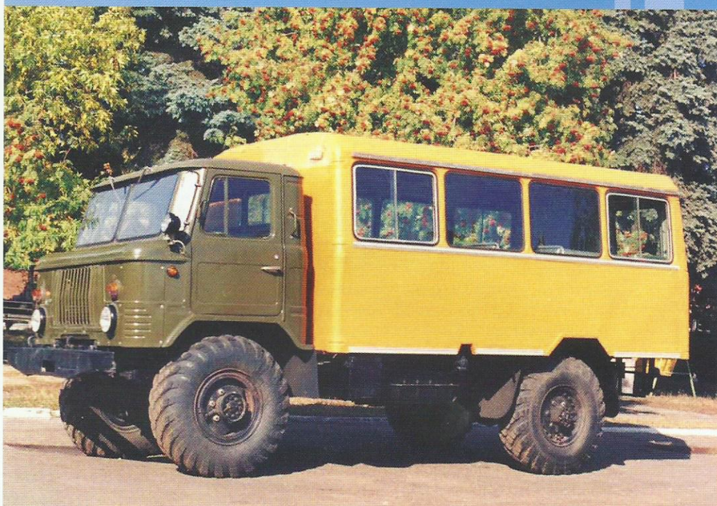
➤ Вахтовый автобус модели 39641 на шасси ГАЗ-66
