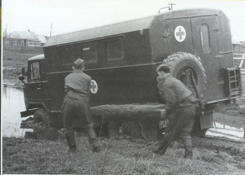
⚡ Санитарный автобус АС-66 на шасси грузовика ГАЗ-66
