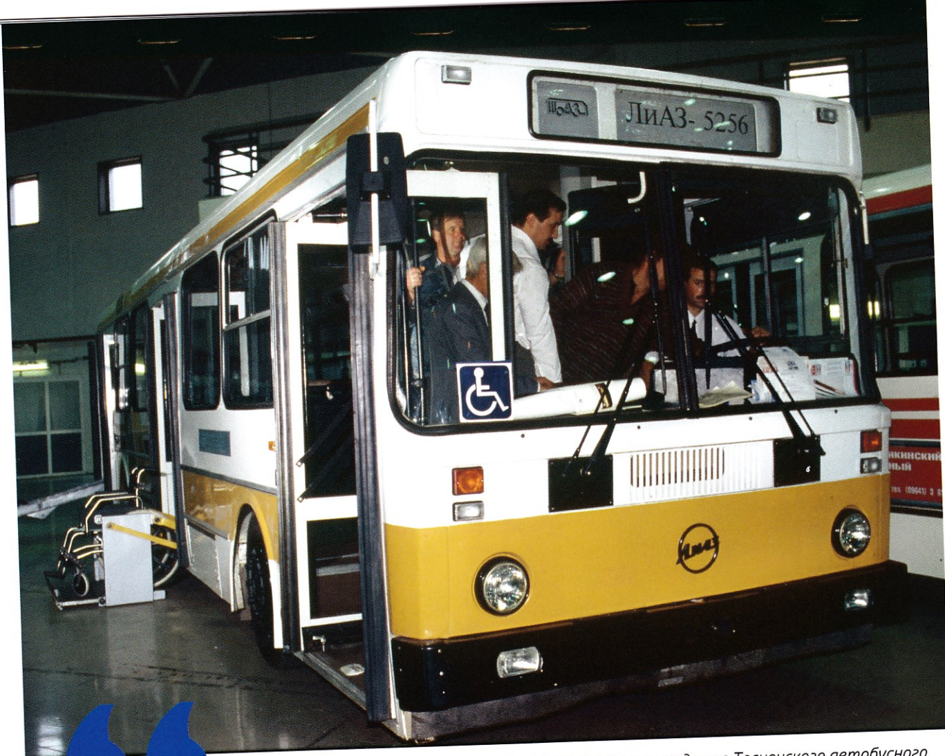
➤ Автобус ЛиАЗ-5256 производства Тосненского автобусного завода с подъемником для инвалидов колясок
