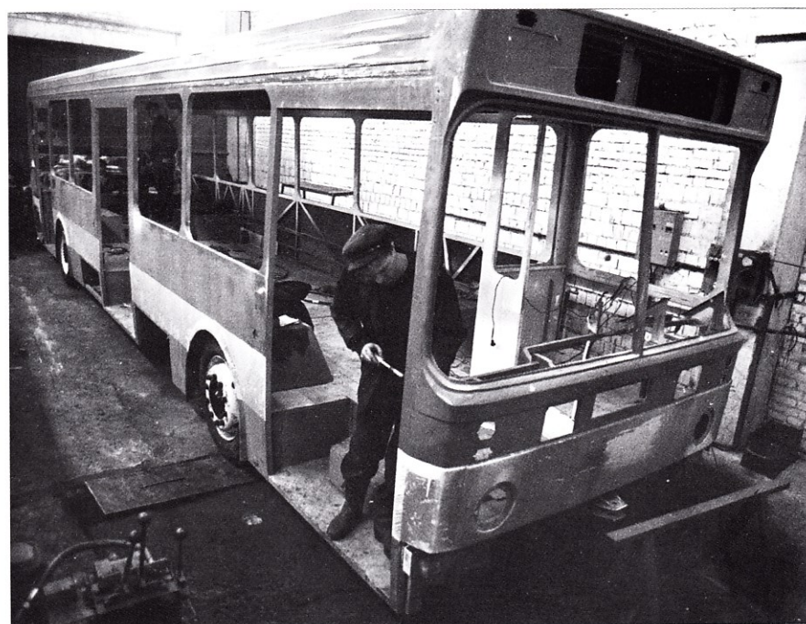
➤ Сборка автобуса ЛиАЗ-5256 на ТоАЗ
