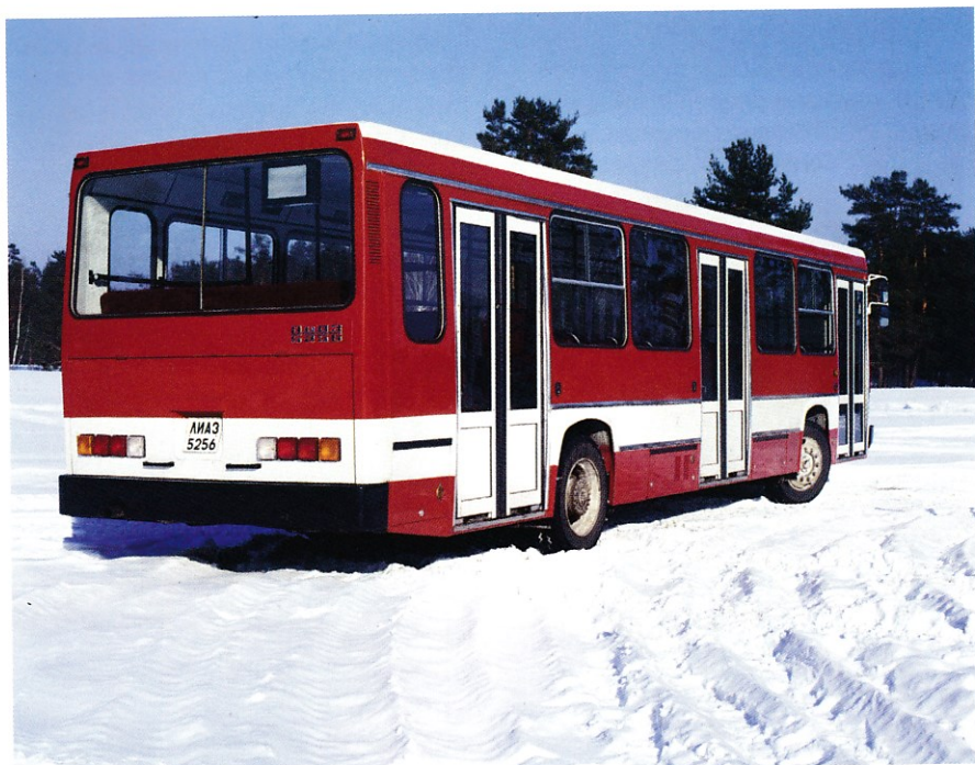
⚡ На автобусах ЛиАЗ-5256 до 1998 года задние фонари устанавливались горизонтально
