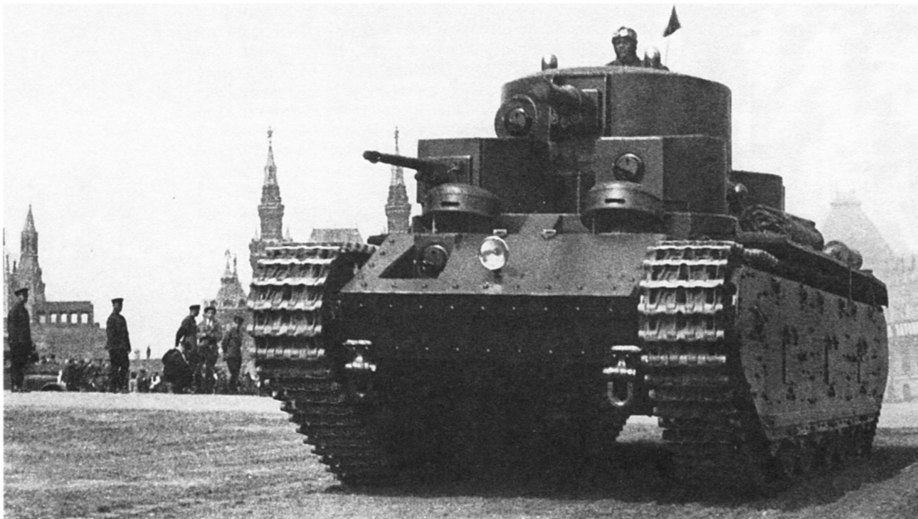
Т-35-2 на параде 7 ноября 1933 года в Москве. Колпаки водителя и стрелка в открытом положении, на левом борту видна укладка брезента (ЦМВС).
