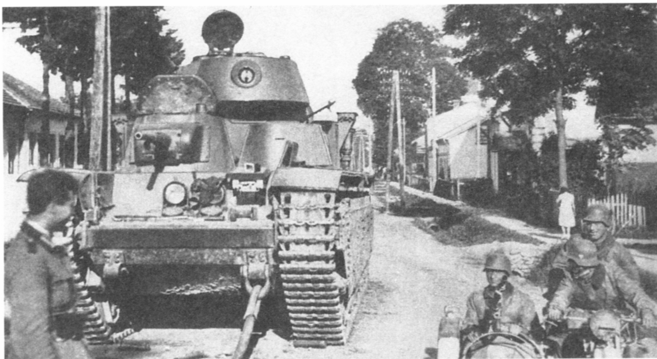
Т-35 выпуска февраля – апреля 1939 года, брошенный экипажем из-за неисправностей. Июль 1941 года. Машина имеет двустворчатый люк механика-водителя, открывающийся в одну сторону и пулеметную установку в нише главной башни (АСКМ).
