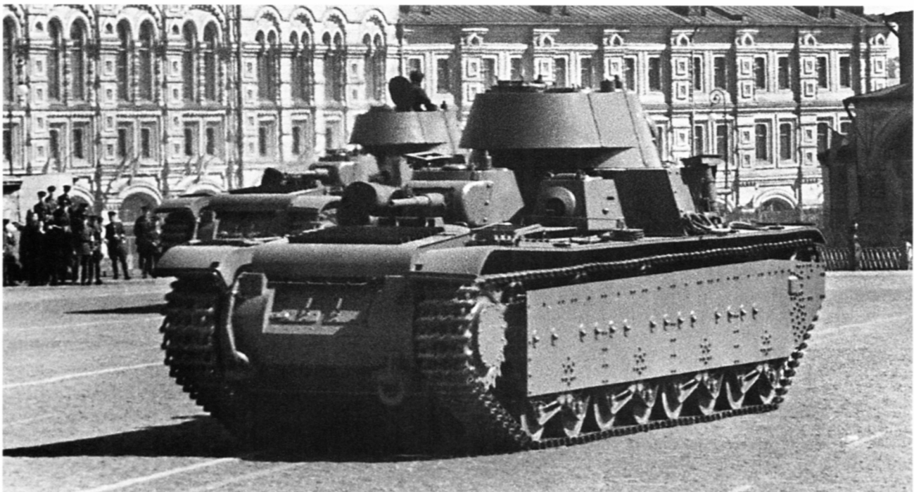
Танки Т-35 с коническими башнями на Красной площади. 1 мая 1941 года. На переднем плане машина выпуска мая — июня 1939 года с наклонной подбашенной коробкой (АСКМ).
