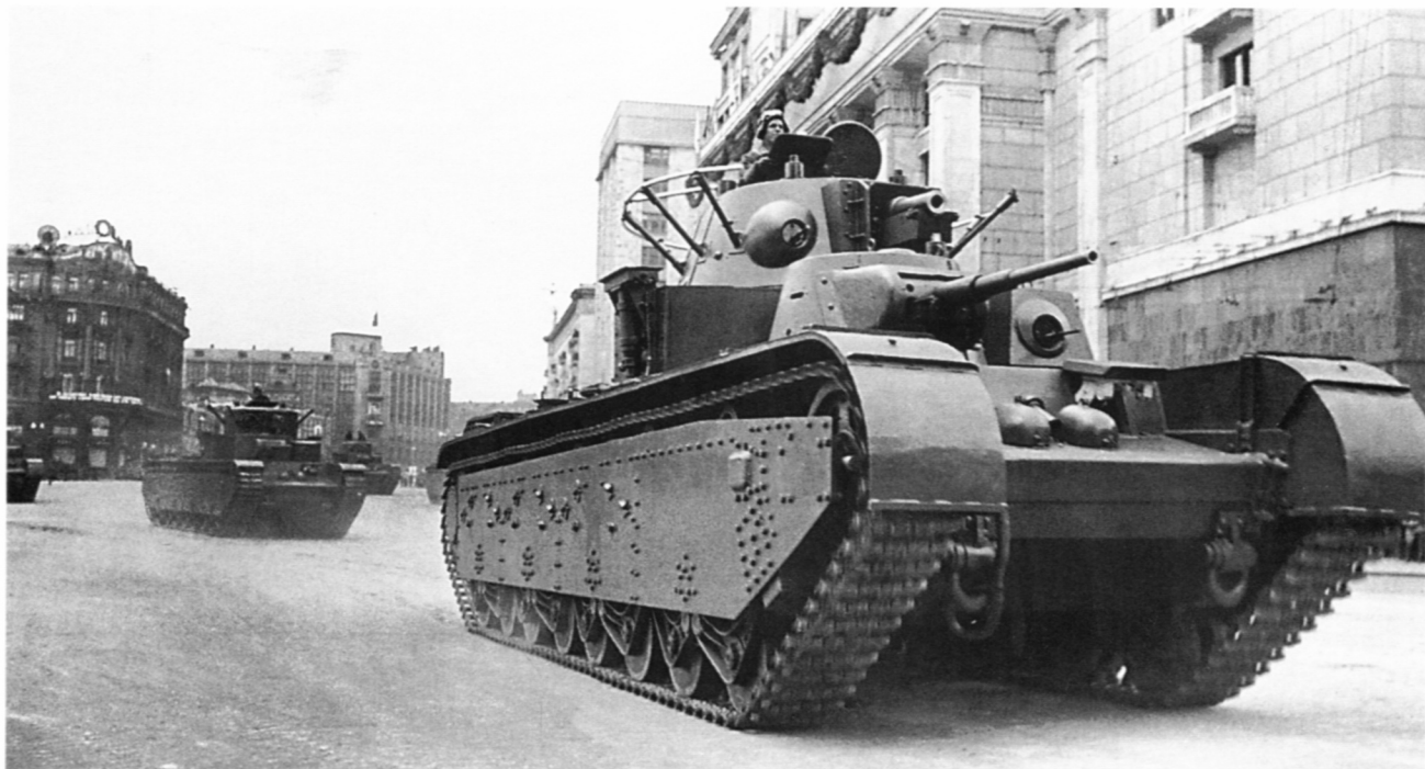
Т-35 по пути на Красную площадь 7 ноября 1940 года. Танк выпуска февраля — апреля 1939 года. Хорошо виден люк механика-водителя толщиной 70 мм, а также специальные брызговики на кромках подгусеничных полок. Кроме этого парада, такие брызговики больше на фотографиях не встречаются. Обращает внимание, что танк с конической башней оборудован поручневой антенной (АСКМ).
