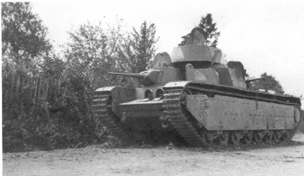
Брошенный Т-35 с коническими башнями. Июль 1941 года. Танк выпуска мая – июня 1939 года с наклонной подбашенной коробкой. Белый треугольник на башне – тактический знак 68-го танкового полка (БА).
