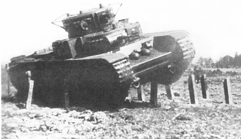
Т-35 5-й тяжелой танковой бригады на учениях. Район Харькова, лето 1936 года. Лестница для залезания на танк уложена на крыше моторного отделения поверх глушителя (ЦМВС).
