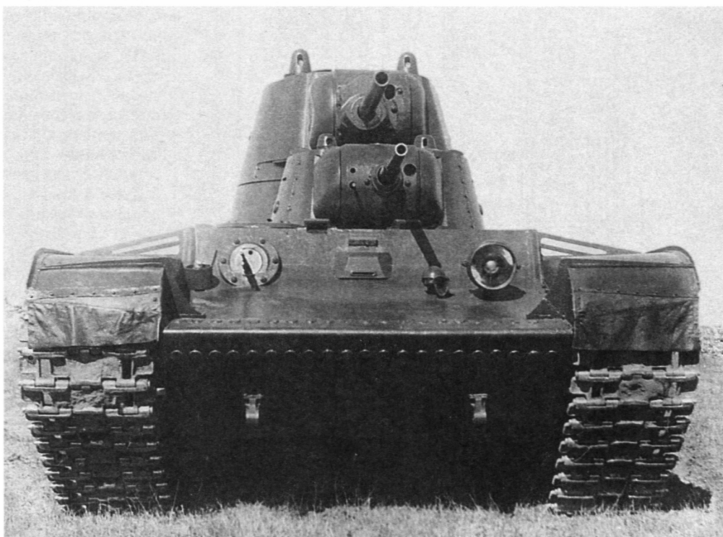
Танк СМК на полигонных испытаниях. Август 1939 года. Хорошо видна форма траков, установка курсового пулемета, фара и звуковой сигнал (АСКМ).
