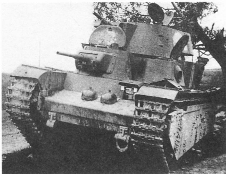
Брошенный Т-35 с коническими башнями. Июль 1941 года. Танк выпуска февраля – апреля 1939 года с прямой подбашенной коробкой. Белый треугольник на башне – тактический знак 68-го танкового полка (БА).
