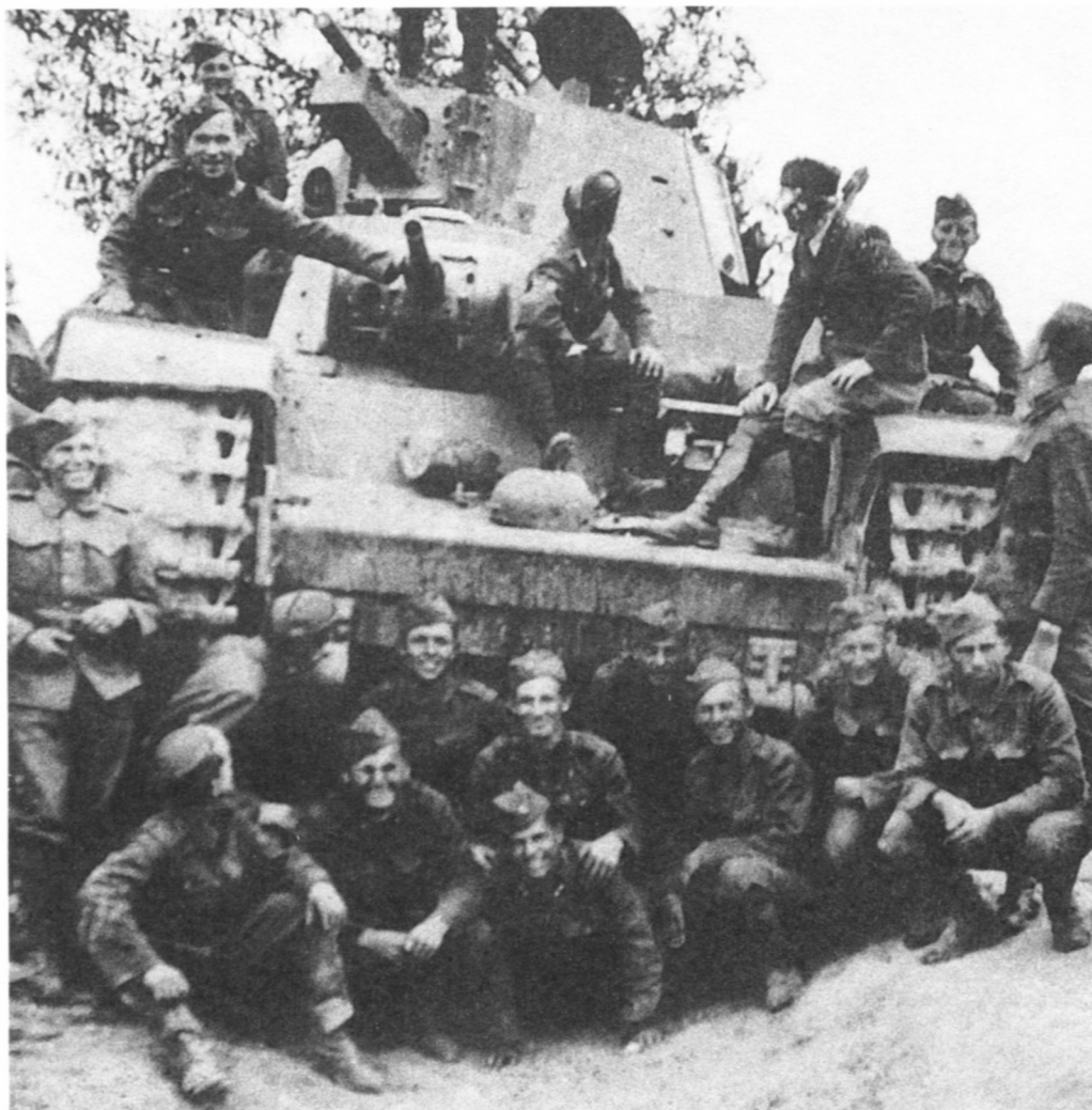
Брошенный Т-35 с коническими башнями. Июль 1941 года. Танк выпуска февраля – апреля 1939 года с прямой подбашенной коробкой. Белый треугольник на башне – тактический знак 68-го танкового полка (БА).
