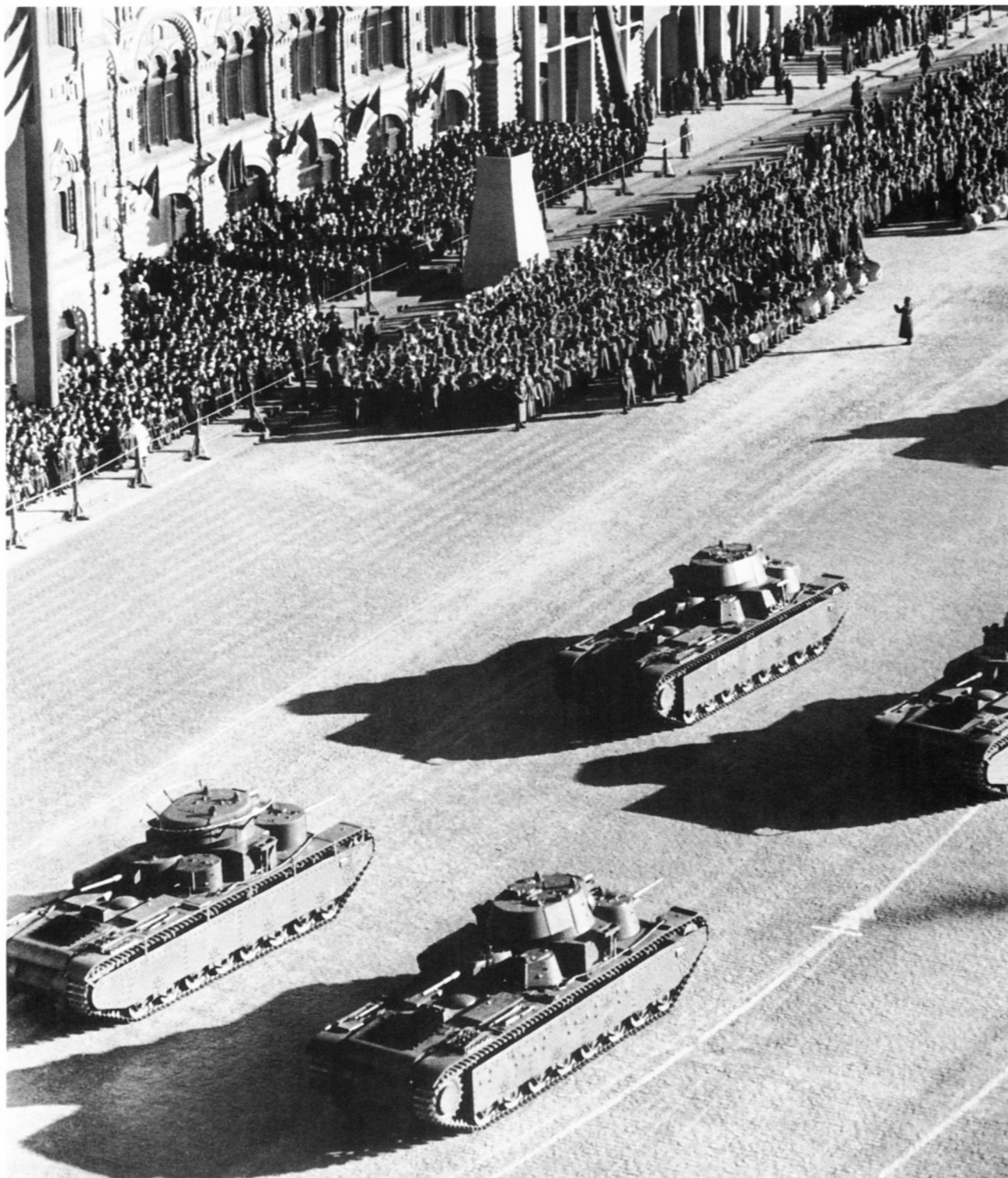
Танки Т-35 проходят по Красной площади. 7 ноября 1940 года. На фото два танка выпуска 1939 года — с прямой и наклонной подбашенными коробками и люками разной формы в бортовых экранах и один танк выпуска 1936 года — с модернизированной системой выхлопа (глушитель убран внутрь корпуса), антенной на восьми стойках, но еще с общим люком в башне (РГАКФД).
