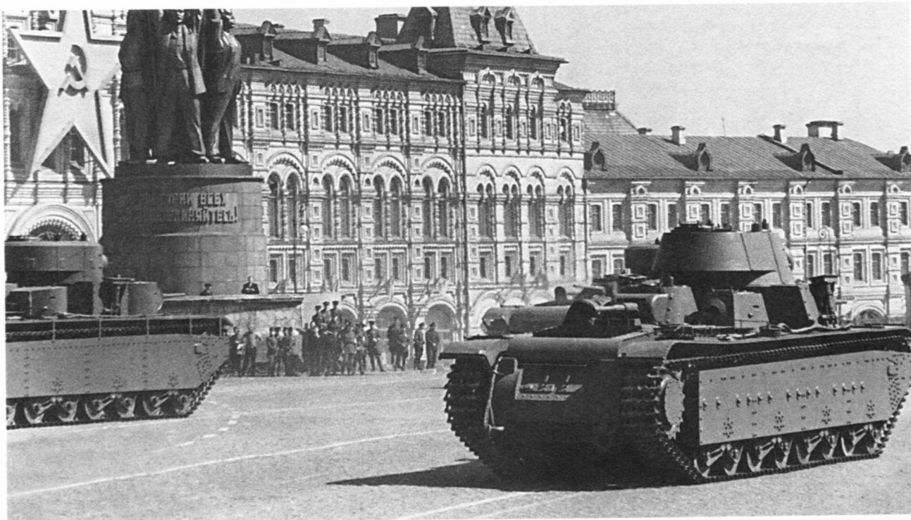
Танки Т-35 с коническими башнями на Красной площади. 1 мая 1941 года. На фото машины выпуска февраля – апреля и мая – июня 1939 года. Хорошо видны их основные отличия – прямая и наклонная подбашенные коробки и форма люков для доступа к подвеске в бортовых экранах (АСКМ).
