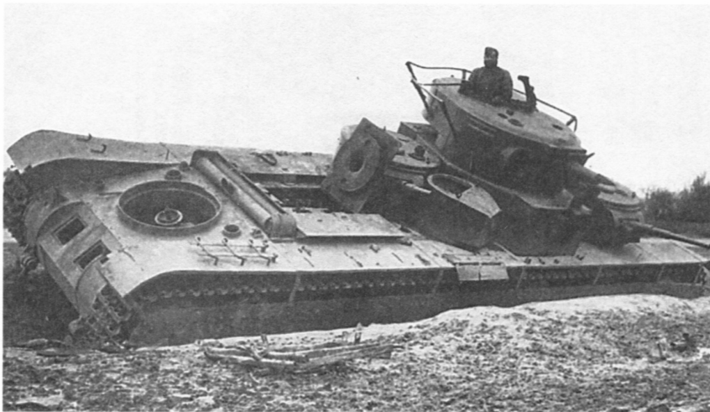
Брошенный экипажем Т-35. Фото сделано осенью 1941 года. Машина выпуска 1936 года: с ранним типом глушителя и двумя люками в главной башне (БА).
