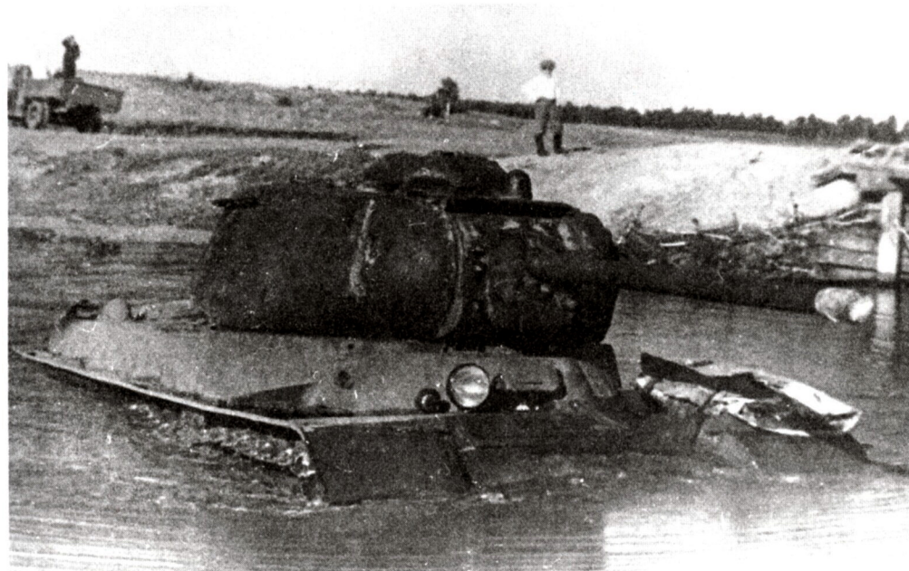
Объект 237 (ИС №1) в ходе заводских испытаний преодолевает вброд водную преграду. Челябинск, июль 1943 года.
