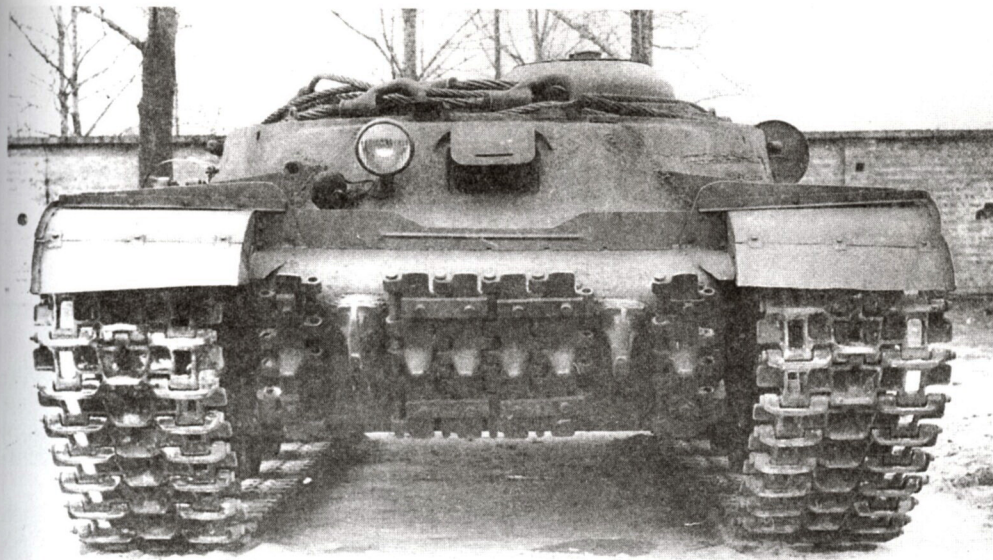
Эвакуационный тягач ИС-2Т. В такие машины в 1950-х годах было переделано некоторое количество тяжелых танков.
