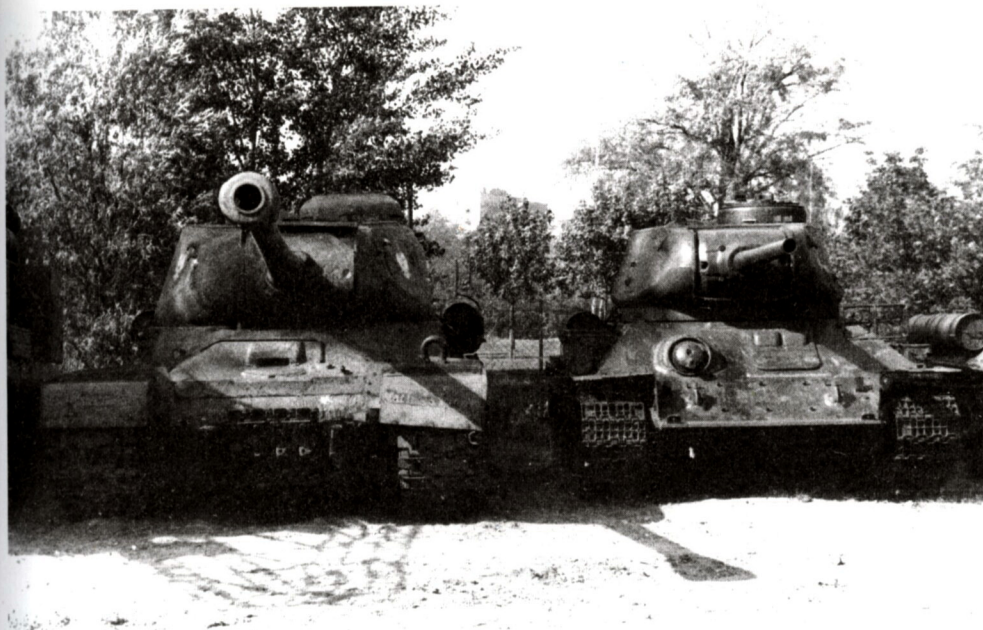
ИС-2 и Т-34-85. На фото хорошо видно насколько невелик тяжелый танк по сравнению со средним при разнице в массе 15 т.
