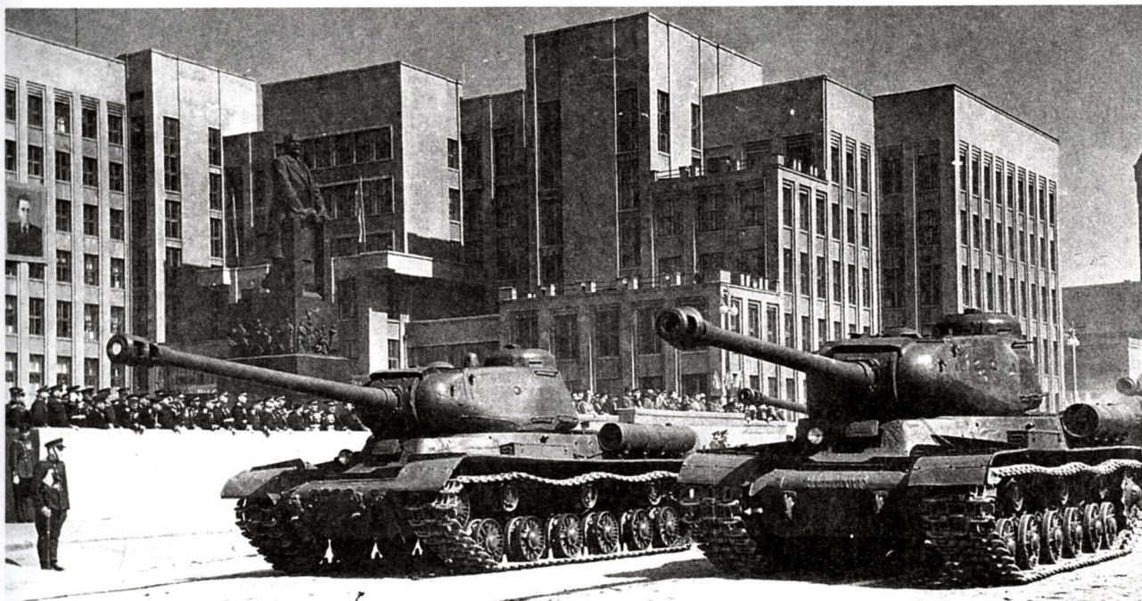
Парад в Минске 1 мая 1952 года. На переднем плане ИС-2 раннего выпуска. У машины справа — дульный тормоз пушки немецкого типа; кроме того, вместо перископического прицела ПТ-17 у нее установлен прибор наблюдения МК-4.
