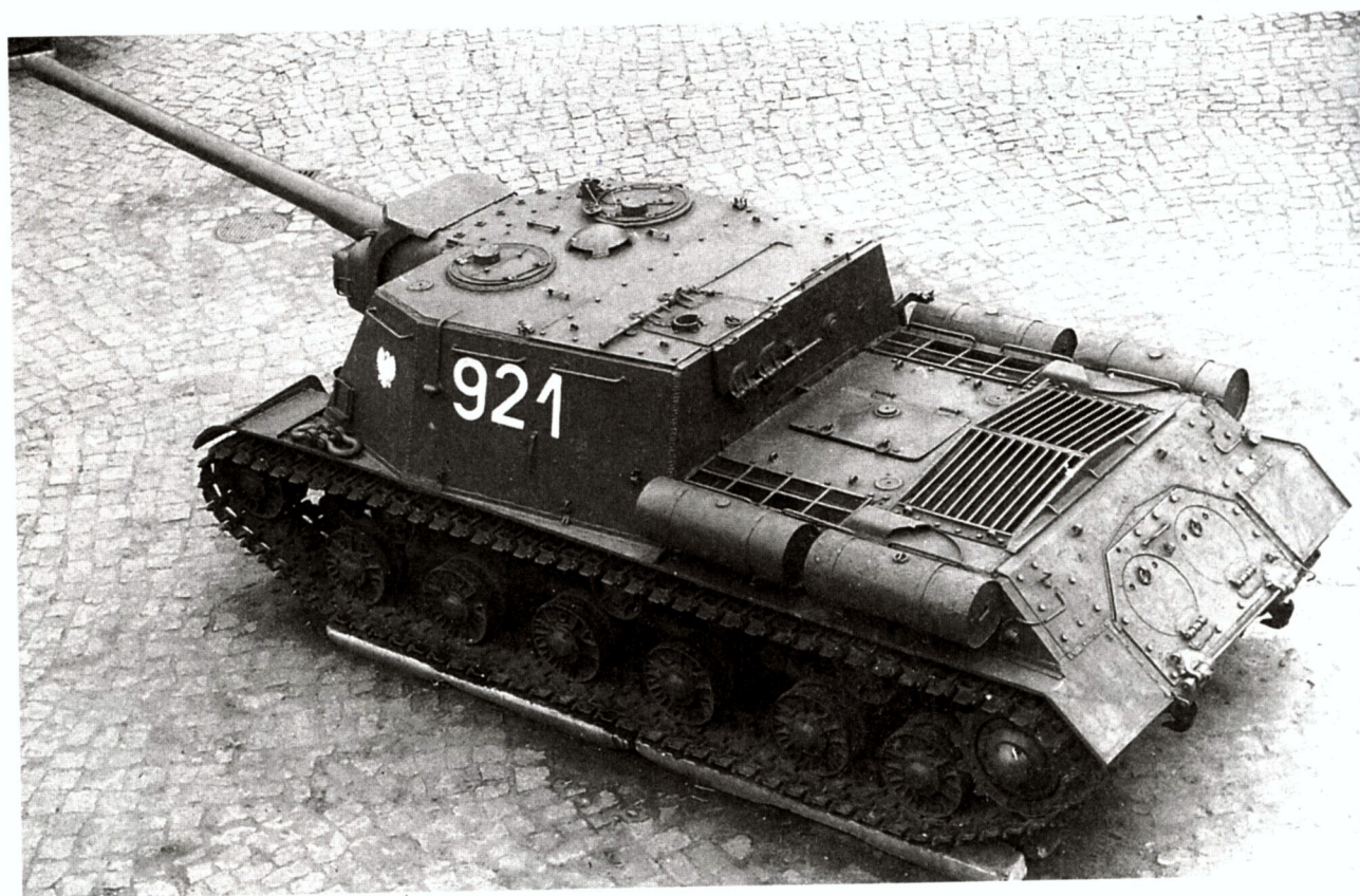
Артсамоход ИСУ-122 в Музее освобождения Познани, Польша. Хорошо видно, что внешне ничем кроме ствола пушки от ИСУ-152 эта машина не отличается.
