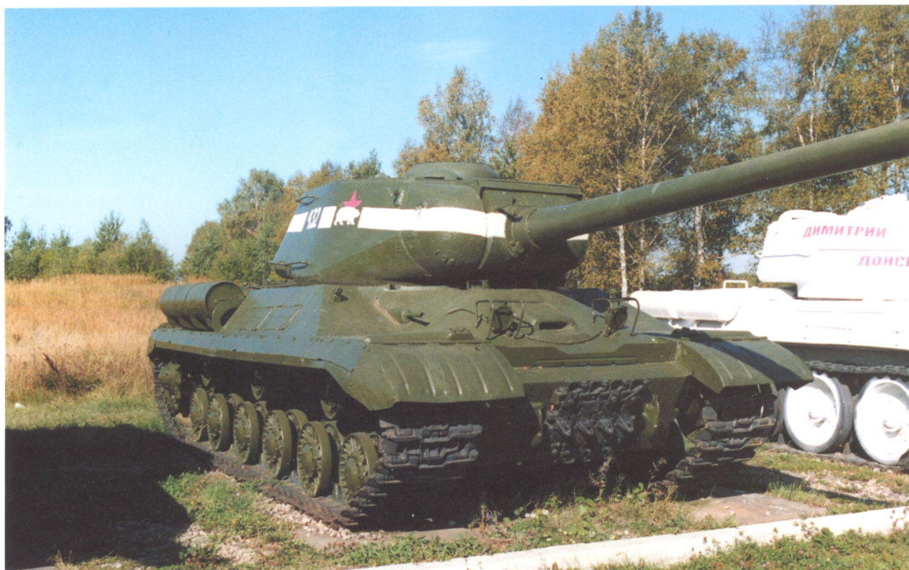
Тяжелый танк ИС-2М со спрямленной сварной носовой частью производства УЗТМ. Военно-исторический музей бронетанкового вооружения и техники в Кубинке, 2005 год.
