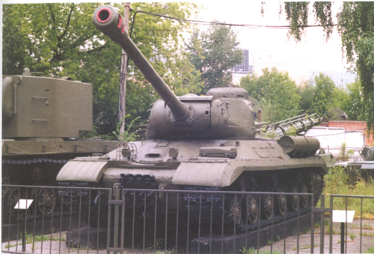
Тяжелый танк ИС-2М со спрямленной литой носовой частью. Центральный музей Вооруженных Сил, Москва, 2001 год.
