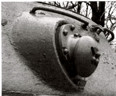
Шаровая установка кормового башенного пулемета.
