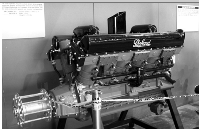
Двигатель «Паккард» 3A-2540. Его более ранняя версия стояла на «Пегасусе»
