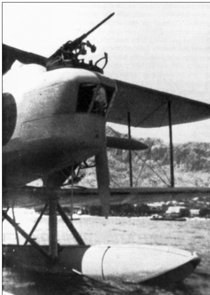
He-59 в Полленсе. Хорошо видна 20-мм пушка на носовой турели самолета
