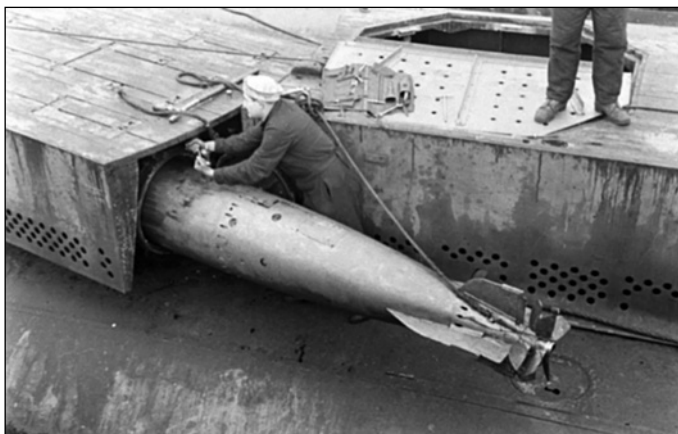
Погрузка торпед на «Вильк». Вверху – в поворотный ТА, внизу (три фото слева) – через торпедопогрузочный люк
