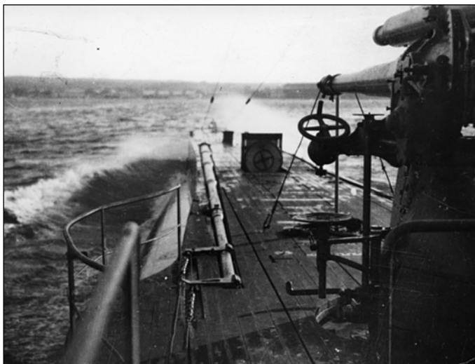
Подводная лодка «Вильк» на маневрах в 1930-е годы. Хорошо видно палубное 100-мм орудие и открытый люк
