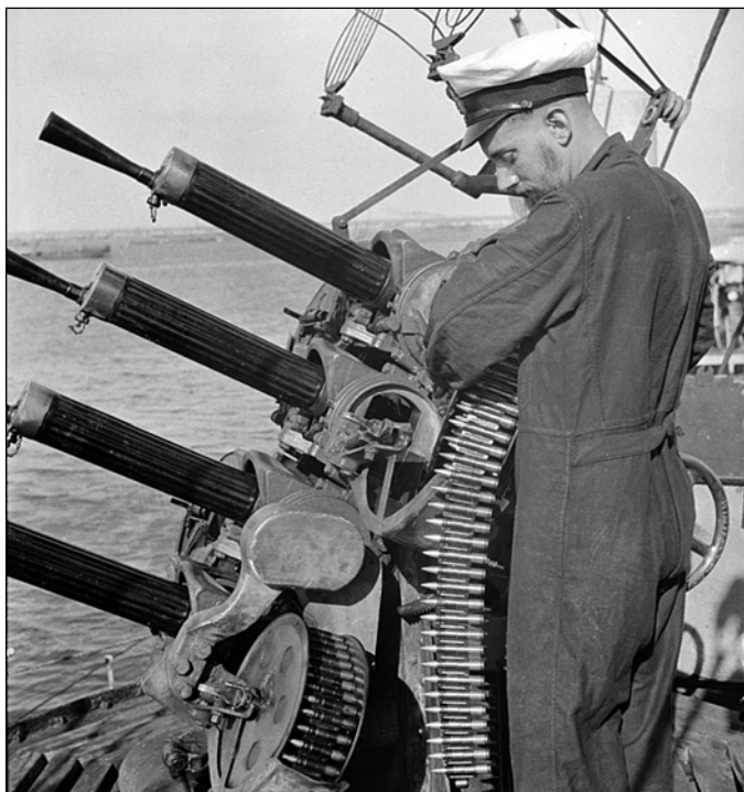
Счетверенный 12,7-мм зенитный пулемет «Виккерс» крейсера «Линдер» (фото июля 1941 г.)
