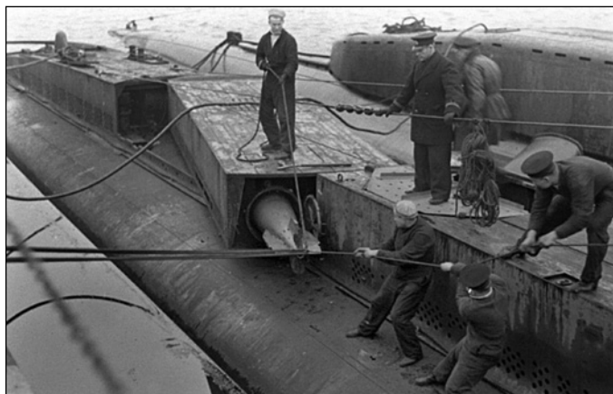
Погрузка торпед на «Вильк». Вверху – в поворотный ТА, внизу (три фото слева) – через торпедопогрузочный люк
