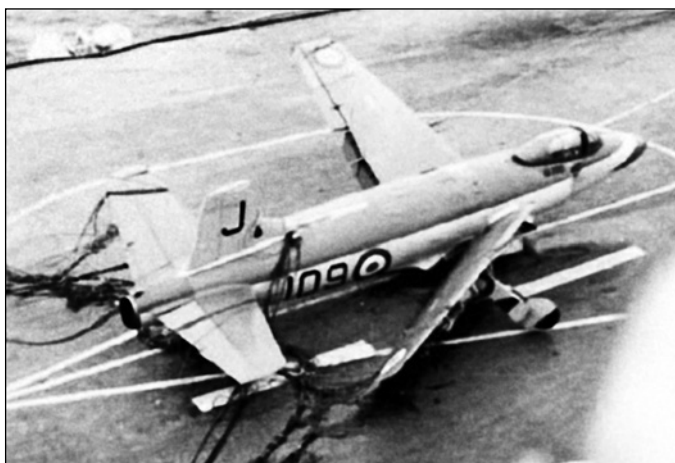
Бывало и такое... «Эттэкер» FB.2 (WP304) из 803-й эскадрильи при посадке на палубу «Игла» проскочил тормозные тросы и был остановлен аварийным барьером, снеся правую консоль крыла. 17 марта 1954 г.
