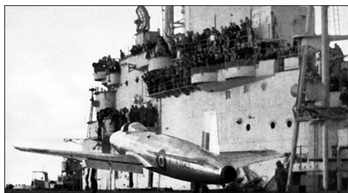
Второй прототип (TS413) был частично «оморячен»: он получил посадочный гак, но механизм складывания крыла еще отсутствовал. Авианосец «Илластриес», октябрь 1947 г.
