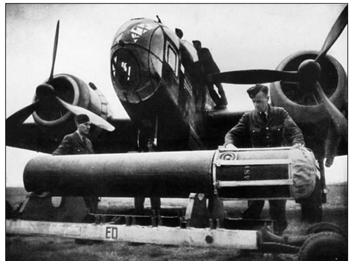
Английская неконтактная мина А Mk.I, поставлявшаяся по ленд-лизу в СССР
