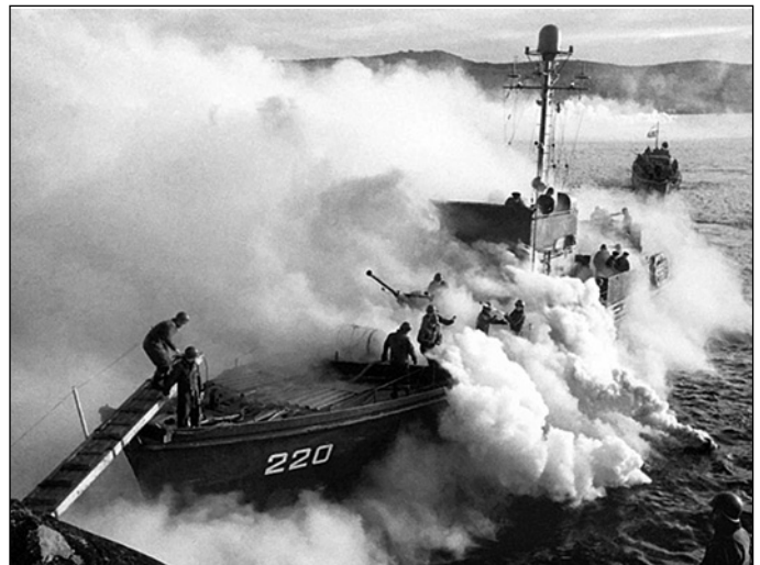
Полученный по ленд-лизу большой охотник за подводными лодками БО-220 типа SC. На топе мачты установлена антенна РЛС SF-1. Северный флот, 1944 г.
