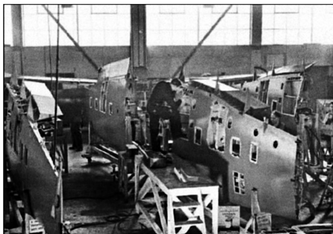
Сборка крыла «Эттэкерв»
